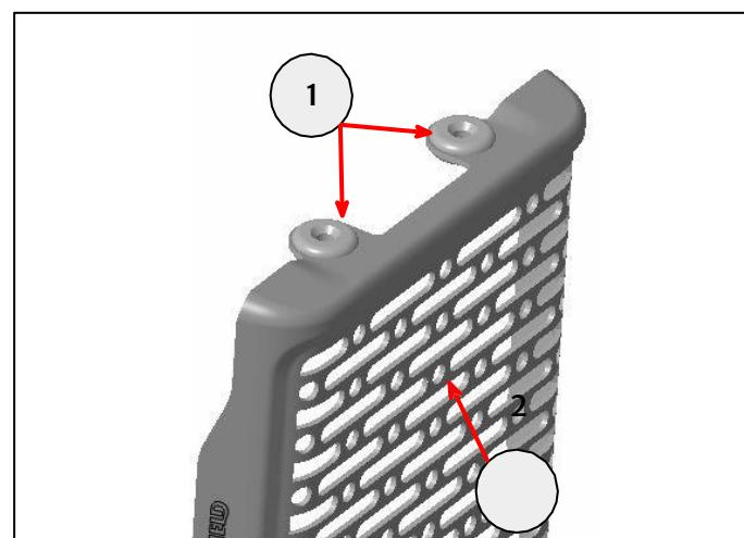
**7** Posicione a parte superior do novo protetor do radiador de óleo (1) nos pinos de localização do radiador de óleo (2) e empurre para baixo. Usando as fixações do kit e as porcas removidas na etapa 4 (3), prenda o radiador de óleo e o novo protetor do radiador aos suportes inferiores. Aperte a 10 Nm.
