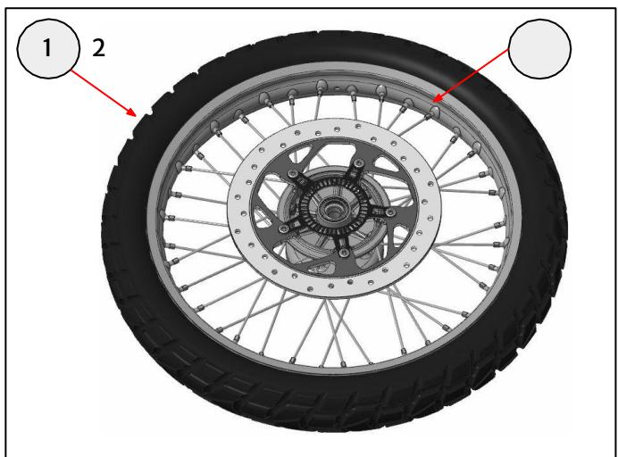
**3** Installer le pneu (1) sur la roue neuve (2). La flèche de rotation du pneu doit pointer vers l'avant.
