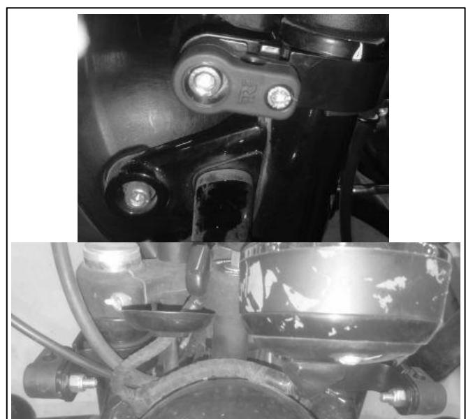
**10** Deslide as barras de montagem do para-brisa touring (5,6) para dentro das montagens inferiores (2).
