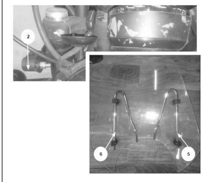
**11** Posicione o para-brisa touring (1) na altura desejada. Recomenda-se uma distância mínima de 10 mm em relação à moldura do farol. Certifique-se de que o para-brisa esteja centralizado na motocicleta e, em seguida, aperte os dois parafusos M6 (12) a **4 Nm**.
