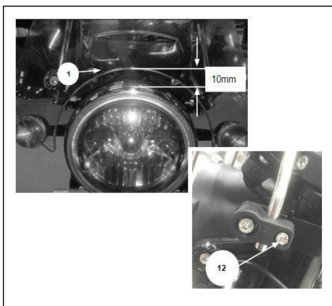
**12** Aperte os 4 parafusos M5 (11) a **3 Nm**.
