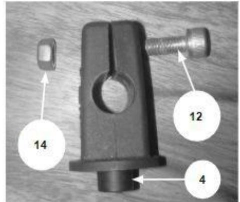
**3** Empurre e encaixe uma porca M5 (14) no bolso das 4 abraçadeiras suporte (4) do para-brisa e monte sem apertar no para-brisa (1) através dos olhais de borracha (3) com um parafuso M5 (10) e uma arruela M5 (16).
