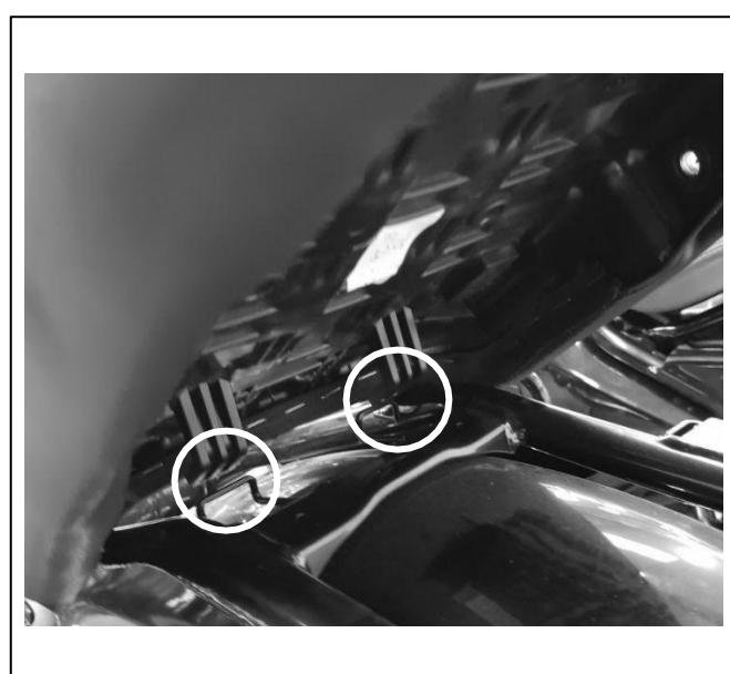
**10** Vuelva a colocar el asa de agarre (4) y fije el conjunto del asiento al bastidor auxiliar utilizando los 4 pernos de cabeza hueca (3) retirados en el paso 5. Apriete a **40 Nm**.
