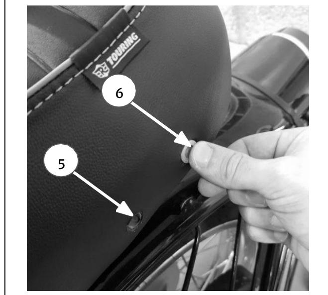
**9** Coloque el nuevo asiento del pasajero de los accesorios colocando los ganchos delanteros en las características como se muestra y luego bajándolo para alinear las inserciones (5 y 6) con los orificios roscados en el bastidor auxiliar.
