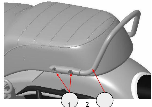
**2** Baue die Sitzbaugruppe (1) aus dem Fahrzeug aus. Für den Fall aufbewahren, dass das Motorrad wieder in seinen ursprünglichen Zustand versetzt werden soll.
