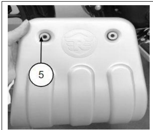
**5** Tenere il paracoppa (1) sulle staffe e assemblare 2 bulloni M6 (6) sulla staffa di montaggio posteriore, senza serrare. Tenere la parte anteriore del paracoppa (1) sulla staffa di montaggio anteriore (2) e assemblare 2 bulloni M6 senza serrare (6). Serrare tutti i 4 bulloni M6 a 8 Nm.
