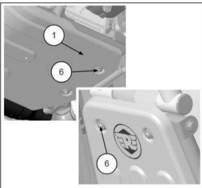
**6** Serrare il bullone del supporto anteriore del motore a 55 Nm.
