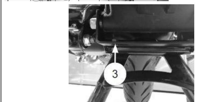
**2** Tenere la staffa di montaggio posteriore (3) parallela al terreno. Utilizzare una chiave per tenere fermo il bullone sul lato sinistro del veicolo; serrare il dado a 55Nm.
