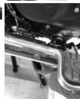
**3** Rimuovere il bullone del supporto anteriore del motore (con freccia), la rondella (3) e il dado a U (1). Assemblare la staffa di montaggio anteriore (2) come illustrato, lasciando il bullone allentato in questa fase.
