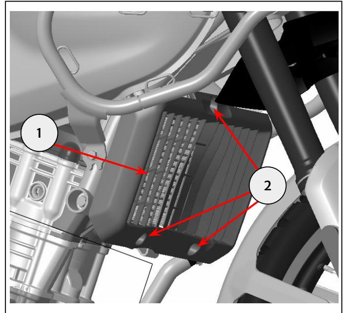
**2** Avec la fixation M6 x 14 mm provenant du kit (1), fixer le dessus de la protection de radiateur neuve (2) sur le dessus du radiateur (3). Ne serrez pas complètement à ce stade.
