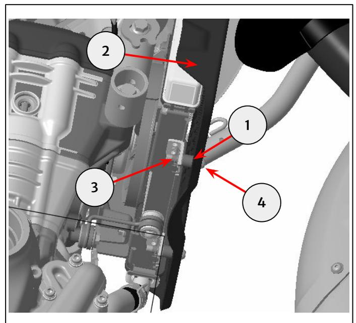
**4** Serrez les fixations inférieures (1) à **10 Nm**. Serrez la fixation supérieure (2) à **10 Nm**.
