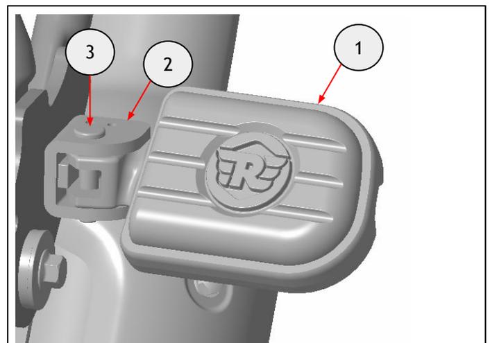
**9** Coloque la arandela de retención (1) retirada en el paso 4 en la ranura de la horquilla.
