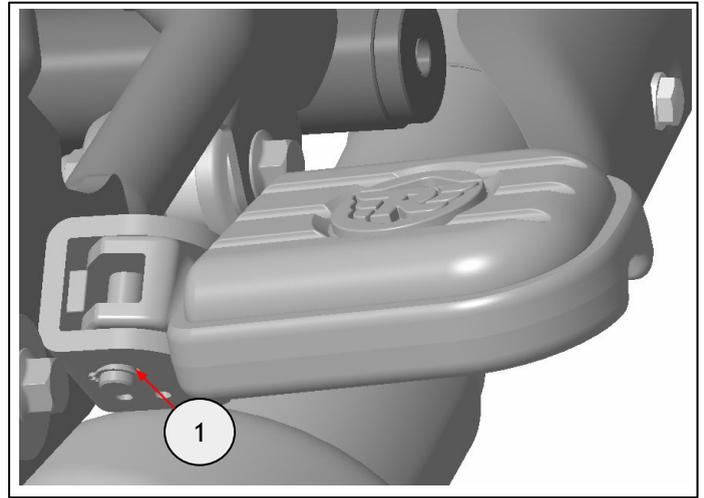
**10** Asegure firmemente el reposapiés (1) en posición girada hacia delante, tal como se muestra. Apriete la fijación (2) a 35 Nm.
