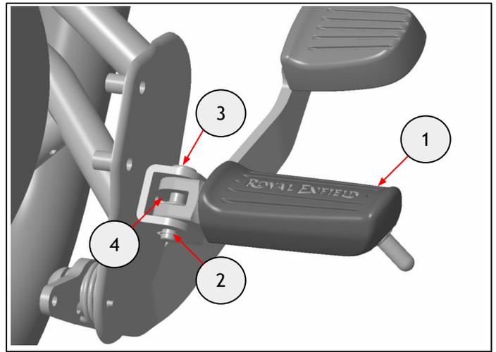
**2** Alinee el orificio de montaje del reposapiés (1) con el orificio de la horquilla (2). Coloque el extremo recto del muelle de retorno (3) en el orificio de la horquilla y el otro extremo contra el reposapiés. Coloque el pasador de horquilla (4) a través de la horquilla, el reposapiés y el muelle.
