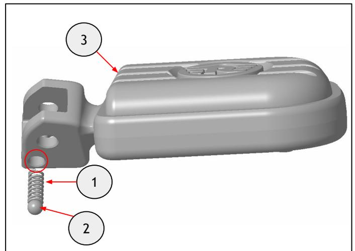
**8** Mientras sujeta el cojinete de bolas y el muelle de retén en su lugar, alinee el orificio de montaje del reposapiés (1) con el orificio de la horquilla (2). Coloque el pasador de horquilla (3) del kit a través de la horquilla y el reposapiés.
