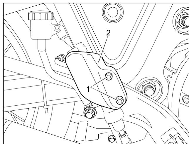
**2** Positionner le protège-talon gauche accessoire (2) sur le cadre de la moto en l'alignant avec les positions des fixations du protège-talon d'origine.
