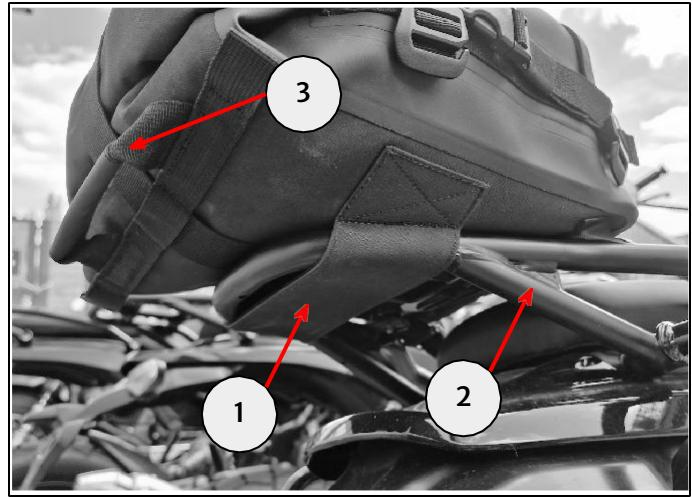
**2** Enrole a cinta de montagem longa direita (1) em torno do ressalto de montagem dianteiro esquerdo do porta-bagagem (2).
