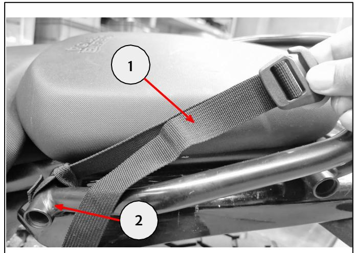
**3** Posicione cada gancho em G (1) através da alça de tecido (2) na parte inferior da bolsa traseira e tensione ambas as cintas de montagem (3).
