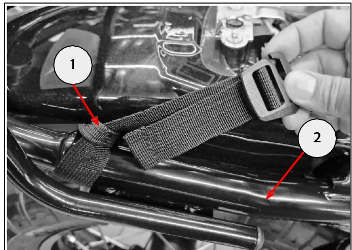
**10** Enrole a cinta de montagem longa esquerda (1) em torno do tubo direito do quadro (2), à frente do tubo inferior (3), como mostrado.
