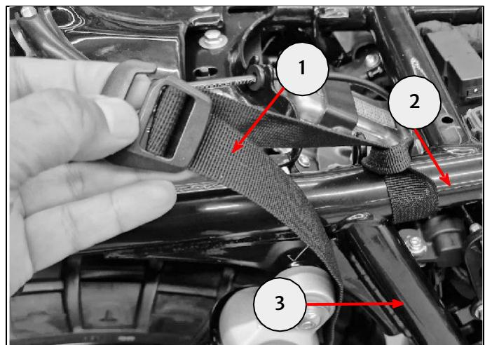
**11** Posicione a bolsa traseira lateralmente sobre o assento. Posicione cada gancho em G (1) nas alças de tecido (2) na parte inferior da bolsa traseira.
