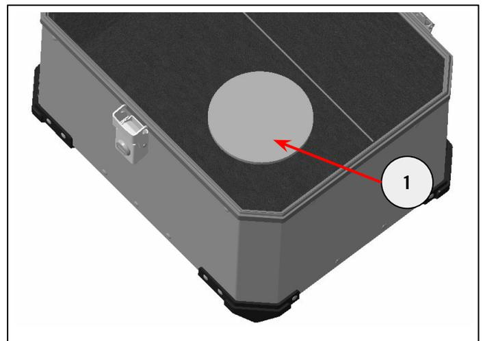
**8** Limpie la parte superior (1) y la parte delantera del baúl (2) con la toallita incluida en el kit. Deje que se seque por completo.
