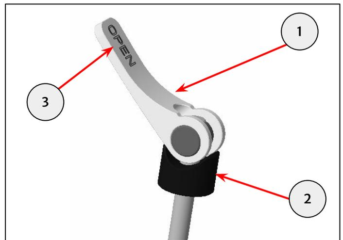
**5** Abra la tapa del baúl y enrosque la palanca (1) en la placa superior desde el interior del baúl. Con la palanca en la posición OPEN (abierto) (2), enrosque el eje hasta que la copa de la palanca (3) haga contacto con la base del baúl.
