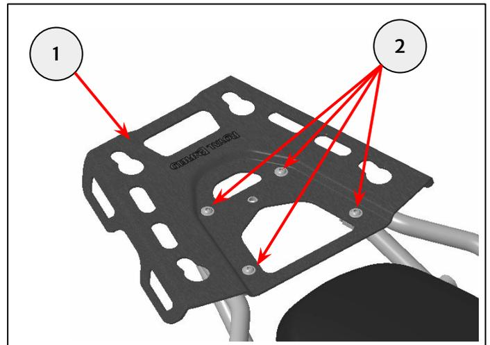
**3** Posicione el baúl (1) sobre la placa superior, alineando las bobinas con los cuatro orificios grandes (2). Empuje el baúl hacia la parte trasera de la motocicleta para que las bobinas se introduzcan en los orificios pequeños (3).
