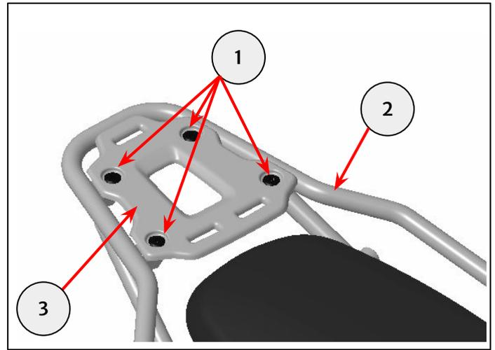
**2** Coloque la nueva placa superior (1) sobre el portaequipajes trasero. Coloque las cuatro fijaciones (2) del kit. Apriete a 13 Nm.
