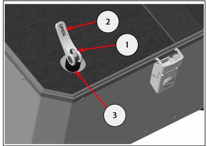
**6** Con la copa de la palanca en contacto con la base del baúl, gire la palanca una vuelta más y cierre completamente la palanca. Si la leyenda OPEN es visible (1), la palanca no está cerrada.
