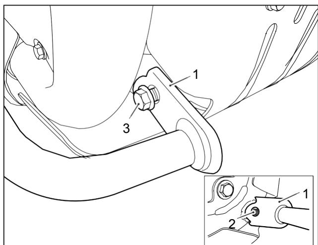
**7** Mientras sujeta la tuerca de fijación del soporte de motor superior en el lado derecho de la motocicleta, apriete la fijación del soporte de motor superior a **50 Nm**.
