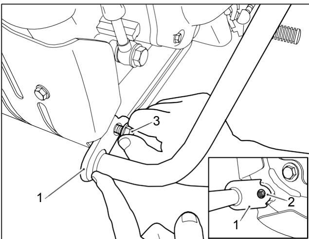
**5** Coloque el soporte superior del protector de motor derecho (1) en la fijación del soporte de motor y vuelva a colocar la tuerca original (2) como se muestra.
