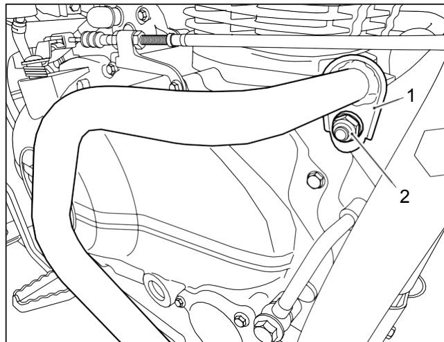
**6** Alinee el soporte inferior de la barra del motor (1) con el punto de montaje en el bastidor de la motocicleta (2). Coloque una fijación M8 x 12 mm (3) del kit.
