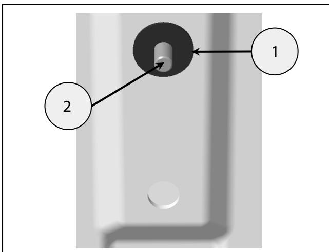
**9** Coloque los soportes de montaje interiores (1) en las fijaciones (2) contra los casquillos bridados (3) con la orientación mostrada.
