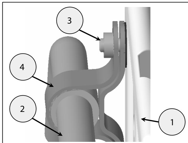
**11** Gire los soportes interiores (1) y coloque casquillos bridados (2) en los orificios de montaje de la caja lateral con la orientación mostrada. Coloque fijaciones M6 x 16 mm (3) a través de los casquillos bridados (2) y los soportes interiores (1) del soporte de montaje (4). Apriete holgadamente las fijaciones en los soportes de montaje exteriores (5), no apriete completamente las fijaciones en esta etapa.
