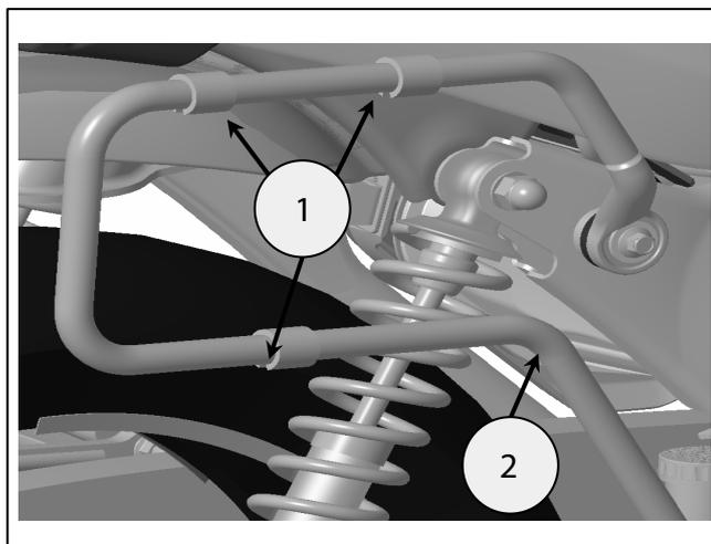
**5** Coloque los soportes de montaje exteriores (1) en las sujeciones de montaje (2) con la orientación mostrada.
