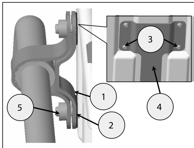
**12** Coloque los separadores (1) en los orificios de montaje inferiores en la caja lateral. Coloque fijaciones M6 x 30 mm (2) del kit a través de los orificios de montaje inferiores del soporte de montaje interno (3) y los separadores (1). Coloque el soporte de montaje interior restante (4) sobre las fijaciones con la orientación mostrada. Apriete holgadamente las fijaciones en el soporte de montaje exterior (5), no apriete completamente las fijaciones en esta etapa.
