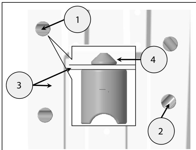
**4** Coloque las sujeciones de montaje (1) del kit en el riel de la alforja del lado derecho (2), tal como se muestra.
