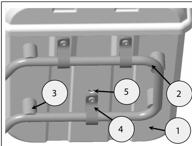
**7** Sin modificar ninguno de los componentes alineados, retire con cuidado la caja lateral del riel de la alforja. Coloque el soporte de montaje interno (1) dentro de la caja lateral y alinéelo con los orificios de montaje de la caja lateral. Coloque dos fijaciones M6 x 16 mm (2) del kit a través de los orificios superiores del soporte interno.
