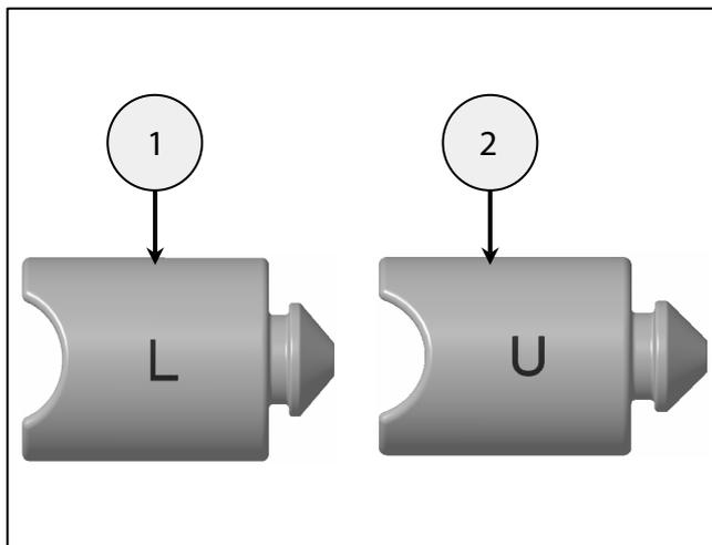
**3** Coloque a presión y gire los soportes de goma superiores (1) e inferiores (2) en la caja lateral (3), tal como se muestra. Asegúrese de que la cabeza (4) de los soportes de goma esté correctamente colocada en el interior de la caja lateral.
