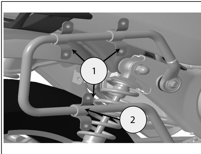
**6** Coloque la caja lateral (1) en el riel de la alforja (2) y ajuste la orientación de los soportes de goma (3) para asegurarse de que la sección de cavidad de los soportes encaje correctamente en el riel de la alforja, tal como se muestra. Ajuste la posición de los soportes de montaje (4) y las sujeciones de montaje (no mostradas) para alinearlos con los orificios de montaje (5) en la caja lateral.
