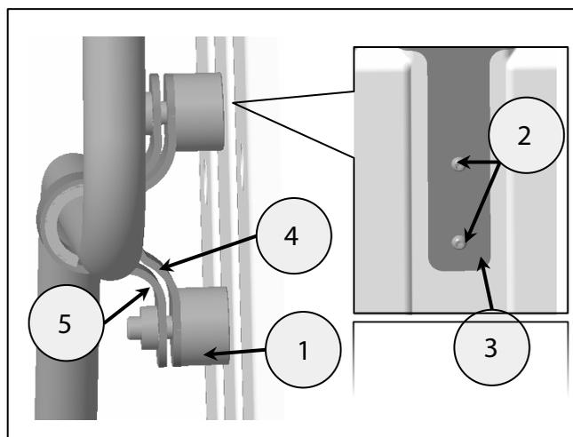
**13** Compruebe que la caja lateral esté correctamente alineada en el riel de la alforja y apriete todas las fijaciones (1) a **8 Nm**.
