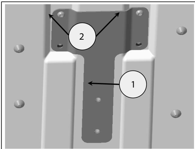
**8** Desde fuera de la caja lateral, coloque los casquillos bridados (1) del kit sobre las fijaciones M6 x 16 mm (2) con la orientación mostrada. Asegúrese de que los casquillos bridados se coloquen correctamente en los orificios de montaje de la caja lateral.
