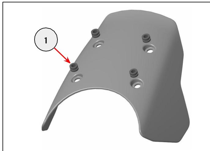
**3** Coloque o para-brisa alto (1) no suporte do para-brisa (2) usando as fixações removidas na etapa 1 (3). Aperte as fixações a 6 Nm.
