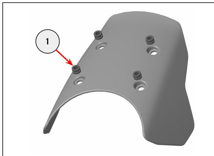
**3** Posez le pare-brise haut (1) sur le support de pare-brise (2) avec les fixations retirées à l'étape 1 (3). Serrez les fixations à **6 Nm**.
