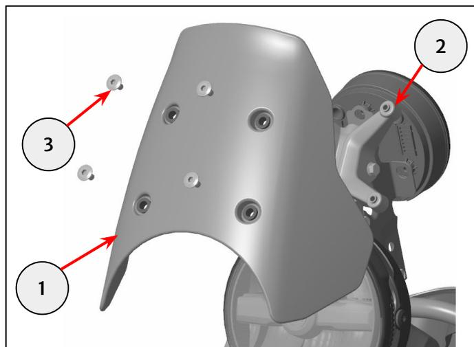
**2** Retirez les quatre œillets en caoutchouc (1) du pare-brise d'origine et posez-les sur le pare-brise haut fourni dans le kit.
