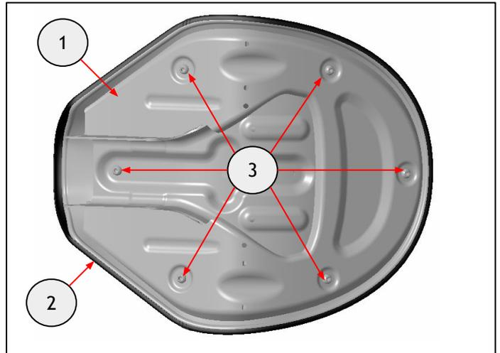
**3** Coloque la base del sillín (1) retirada en el paso 2 en el sillín del conductor Signature (2) utilizando las fijaciones (3) retiradas en el paso 2. Apriete las fijaciones (3) a 7 Nm.
