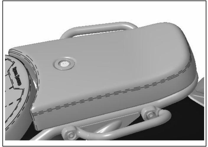
**6** Retire el bloqueo (1) del sillín (2) retirando las fijaciones (3).
