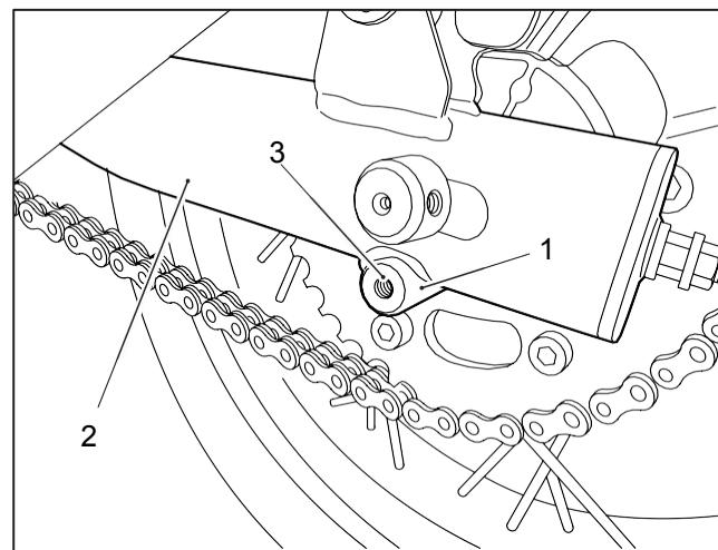
**1** Coloque las bridas de montaje roscadas (1) en la parte trasera del brazo basculante (2), se muestra el lado izquierdo.
