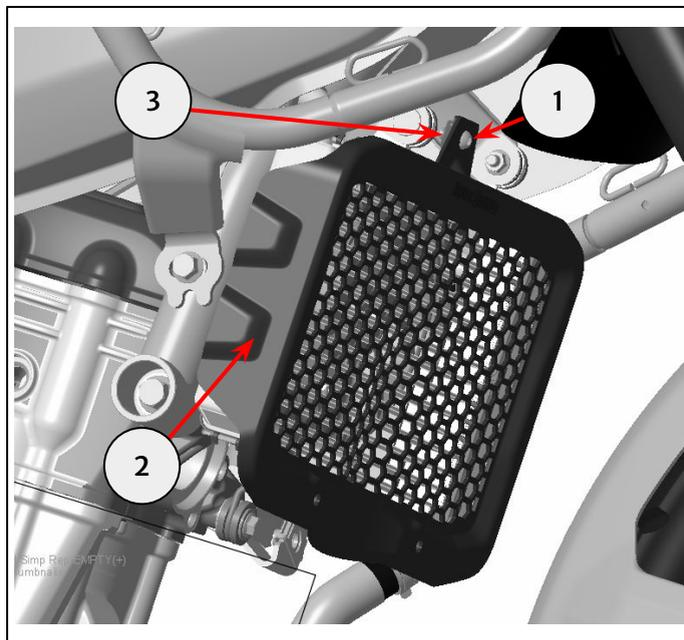
**3** Coloque un separador del kit (1) entre el protector del radiador (2) y el punto de montaje en la motocicleta (3). Coloque la fijación M6 x 35 mm (4) a través del radiador y el separador. No apriete completamente en esta etapa. Repita el procedimiento para los separadores y fijaciones restantes.
