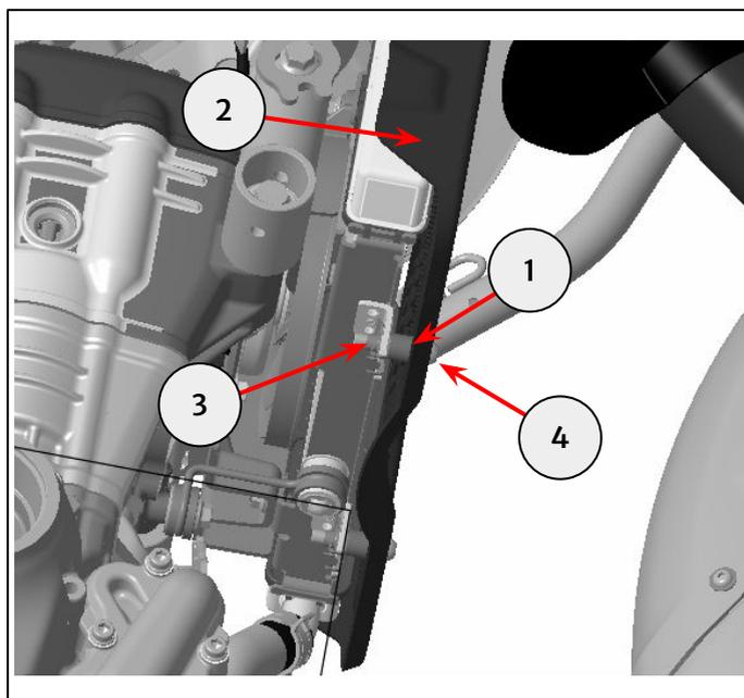
**4** Apriete las fijaciones inferiores (1) a 10 Nm. Apriete la fijación superior (2) a 10 Nm.
