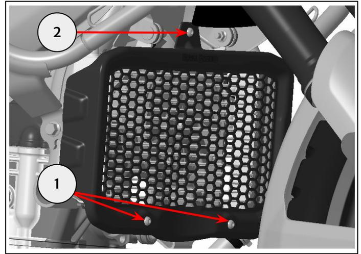
**PRECAUCIÓN:** Compruebe regularmente el protector del radiador en busca de obstrucciones por insectos, hojas o lodo. Elimine cualquier obstrucción con un chorro de agua a baja presión.
