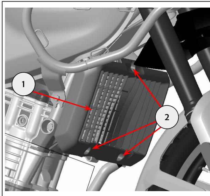
**2** Fije la parte del nuevo protector del radiador (2) a la parte superior del radiador (3) empleando la fijación M6 x 14 mm del kit (1). No apriete completamente en esta etapa.
