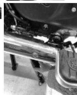
**3** Retire el perno de montaje del motor delantero (flecha), la arandela (3) y tuerca en U (1). Monte el soporte de montaje delantero (2) como se muestra, dejando el perno suelto en esta etapa.
