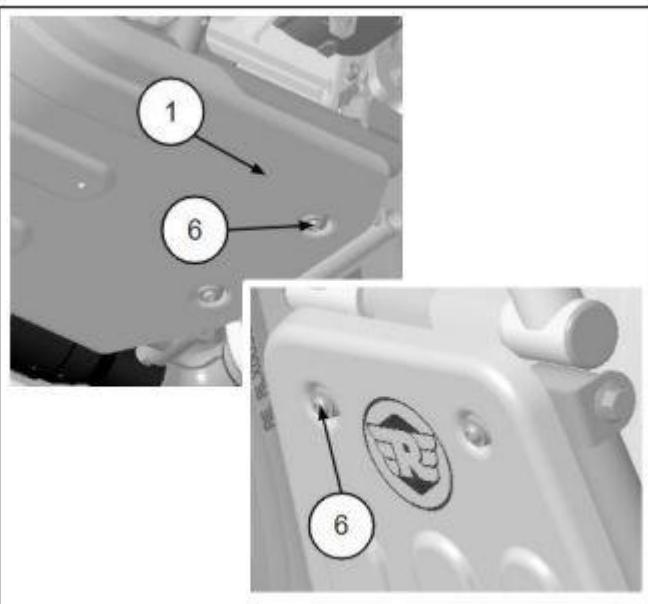
**6** Apriete el perno de montaje del motor delantero a **55 Nm**.
