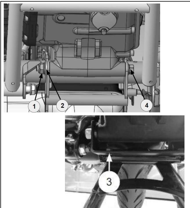
**2** Sostenga el soporte de montaje trasero (3) paralelo al suelo. Utilice una llave de tuercas para sujetar el perno del lado izquierdo del vehículo y apriete la tuerca a 55 Nm.
