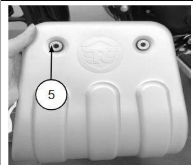
**5** Sostenga el protector del cárter inferior (1) hasta los soportes y monte sin apretar 2 pernos M6 (6) en el soporte de montaje trasero. Sujete la parte delantera del protector del cárter inferior (1) hasta el soporte de montaje delantero (2) y Monte sin apretar 2 pernos M6 (6). Apriete los 4 pernos M6 a 8 Nm.
