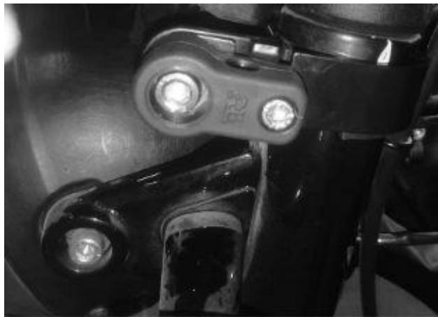
**8** Schiebe die Befestigungsbügel für den getönten Windschild (5) in die unteren Halterungen (2) und positioniere die Scheibe in der gewünschten Höhe zum Scheinwerfer. Es wird ein Abstand von 10 mm zur Scheinwerfereinfassung empfohlen.
