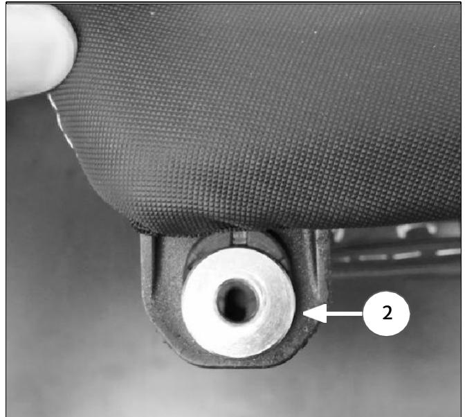
**8** Setze den hinteren Haken des Beifahrersitzes wieder in den Rahmen ein und richte die vorderen Befestigungslöcher aus.
