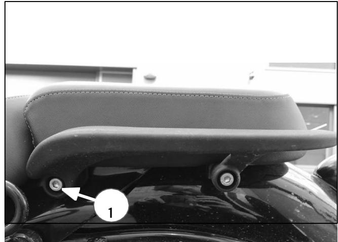
**2** Hebe den Beifahrersitz vorne an und hake ihn aus dem Rahmen aus. Entferne die Flanschhülseneinsätze (2) von der linken und rechten Seite. Zur späteren Verwendung aufbewahren.
