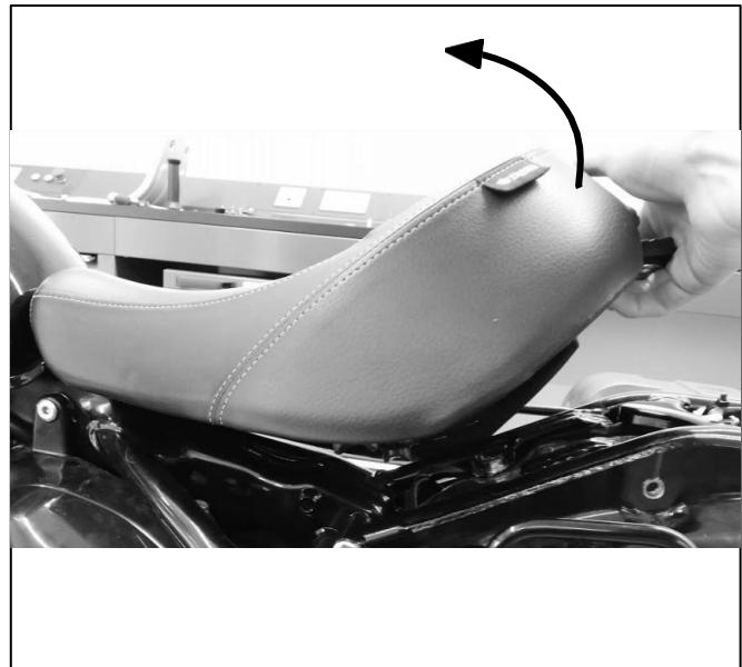
**5** Schiebe das vordere Ende des neuen Zubehör-Fahrersitzes auf die Kraftstoffanklasche und richte den hinteren Befestigungspunkt am Rahmen aus. Bringe 2x Flanschhülseneinsätze (4) wieder an.
