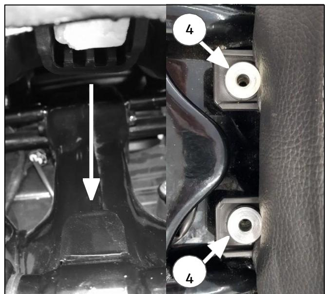
**6** Setze die 2 zuvor entfernten Sechskant-Flanschkopfschrauben (3) ein und ziehe sie auf 12 Nm an.
