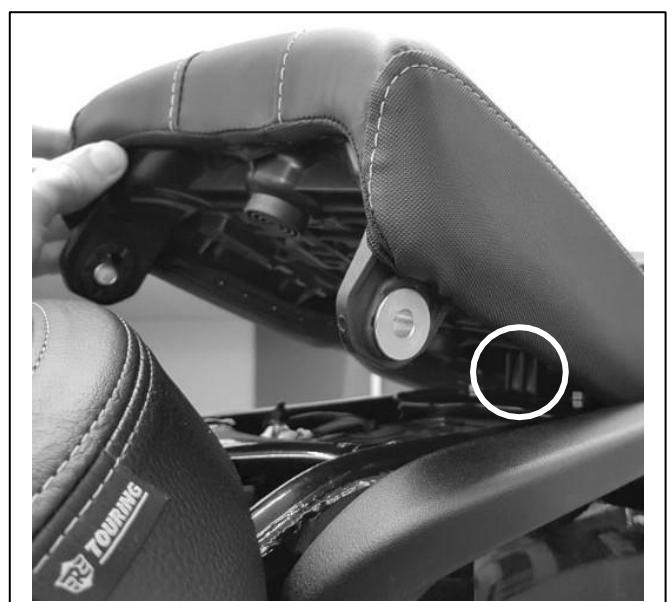
**9** Bring den Beifahrersitz mit der zuvor entfernten Innensechskantschraube (1) wieder an. Durch den Haltegriffansatz in den Rahmen einsetzen. Auf **25 Nm** anziehen und auf der anderen Seite wiederholen.
