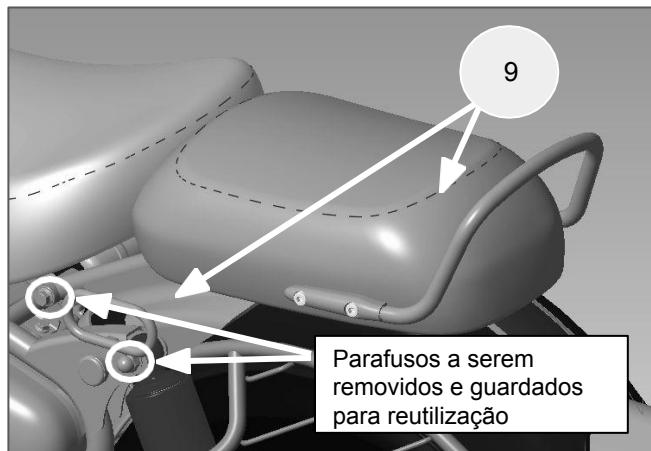
**2** Remova o assento do piloto (10) e guarde-o e os parafusos de montagem para reutilização.
