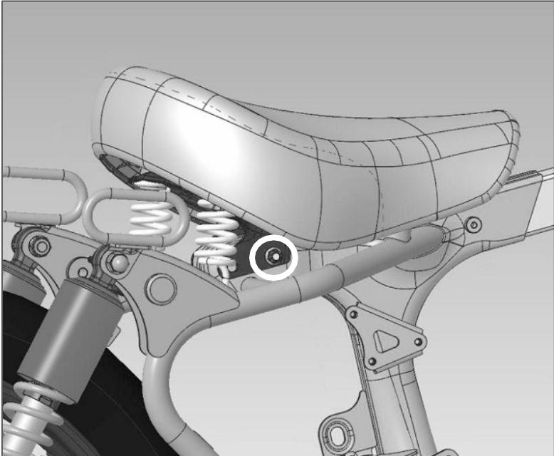
**9** Monte o suporte da mola esquerda do assento (2) sem apertar, usando o parafuso M6 (3). Use uma chave hexagonal de 5 mm
