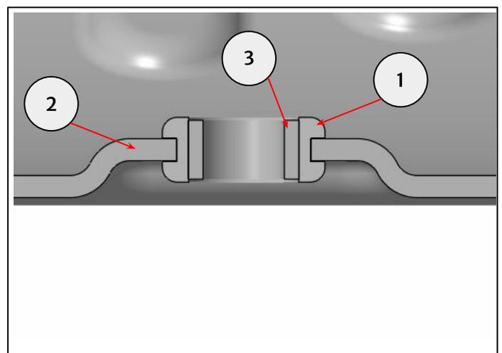
**3** Coloque la fijación M10 x 40 mm (1) del kit para fijar el soporte delantero (2). Asegúrese de que haya contacto entre la pestaña antirrotación (3) y el motor. Apriete las fijaciones a **45 Nm**.
