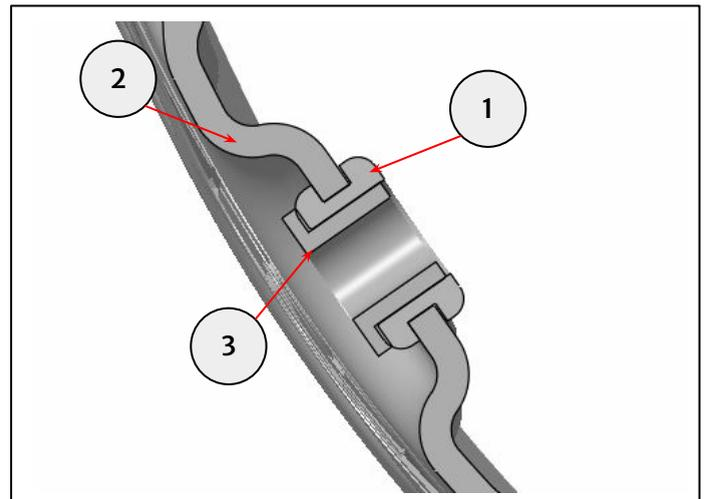
**2** Coloque los pasatubos de goma M10 (1) en el protector del cárter inferior (2). Coloque los separadores 15 x 8 mm (3) en los pasatubos de goma traseros.
