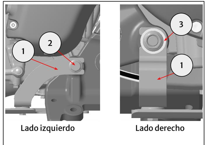
**6** Coloque el protector del cárter inferior (1) en los soportes utilizando las fijaciones M6 x 20 mm del kit (2) con una arandela 19 x 1 mm (3) del kit bajo las fijaciones inferiores. Apriete las fijaciones (3) a **10 Nm**. Apriete las fijaciones del paso 5 a **45 Nm**.
