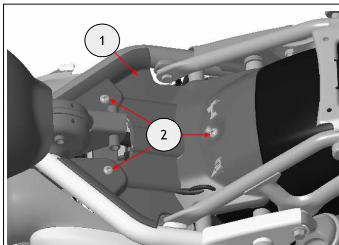
**36** Déposez le support de la centrale (1) en déposant les fixations (2). Conservez les pièces pour les réutiliser, si nécessaire.
