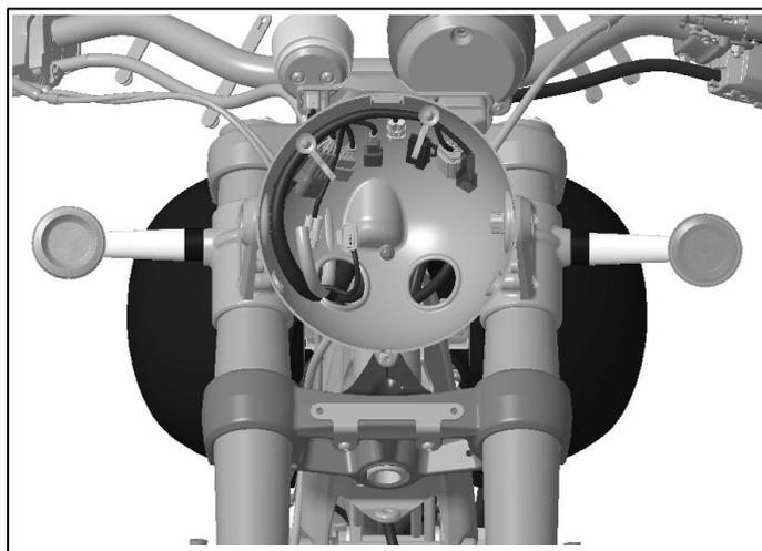
**11** Faites passer les câbles des clignotants dans les trous de la cuvette du phare et rebranchez le clignotant gauche sur le connecteur vert (1) et le clignotant droit sur le connecteur rouge (2).
