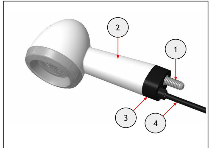
**30** Montez le clignotant (1) sur le carter du phare (2) à l'aide de l'écrou (3) déposé à l'étape 28.
