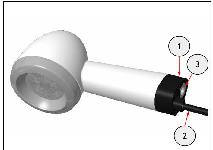
**8** Montez le clignotant (1) sur le support de phare (2) à l'aide de la fixation (3) provenant du kit. Tout en maintenant le clignotant en position à l'aide d'une clé de 24 mm (4), serrez la fixation à 5 Nm.
