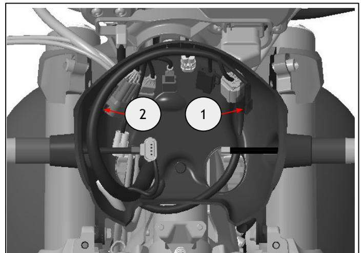
**32** Remontez le cache (1) à l'aide de la fixation (2) déposée à l'étape 26.
