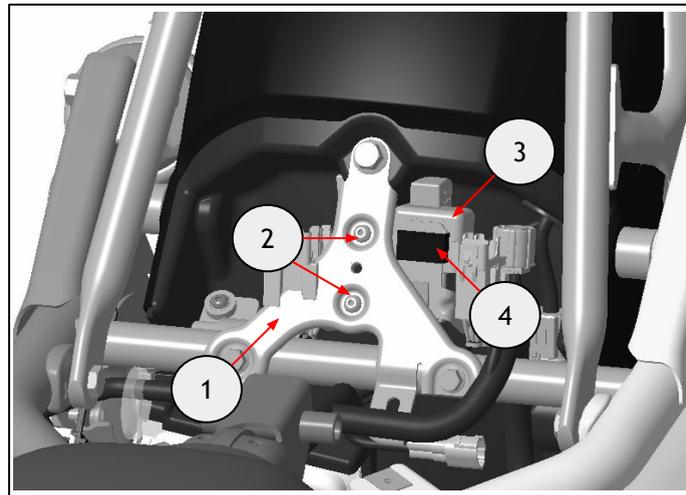
**37** Déposez le câblage d'extension (1) qui n'est pas nécessaire pour ce modèle.
