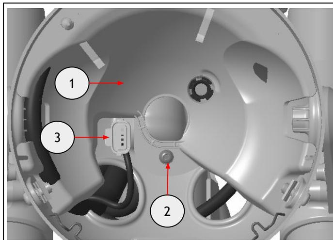
**13** Remontez le bloc phare (1) à l'aide des fixations (2) déposées à l'étape 2.
