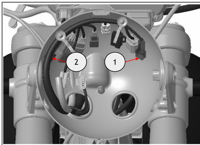
**12** Remontez le cache (1) à l'aide de la fixation (2) déposée à l'étape 3.
