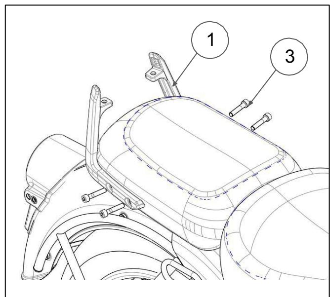
**4** Assembler le dossier (2) avec 2 boulons de capuchon, M8 x 40 (3). Serrer les boulons à **25 Nm**.
