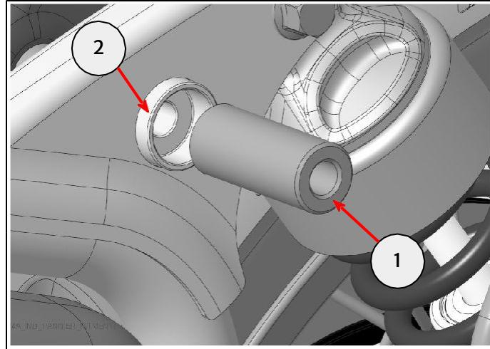
**31** Befestige die obere Aufhängung des linken Taschenträgers (1) mit einer Befestigung M8 x 105 mm (4) aus dem Teilesatz wie gezeigt an dem 55-mm-Distanzröhrenchen (2) und dem Motorradrahmen (3).
