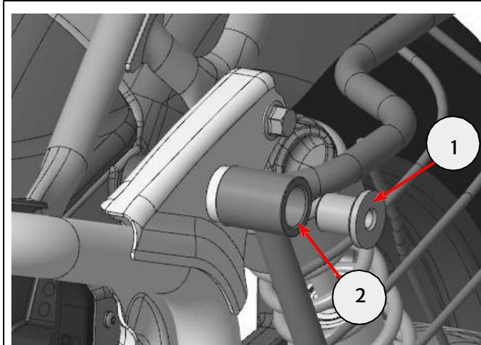
**18** Befestige die obere Aufhängung des linken Taschenträgers (1) mit einer Befestigung M8 x 125 mm (4) aus dem Montagesatz, der in Schritt 16 entfernten Mutter (5), dem in Schritt 16 entfernten Abstandhalter (6) und der Distanzhülse mit Flansch (2) am Motorradrahmen (3).
