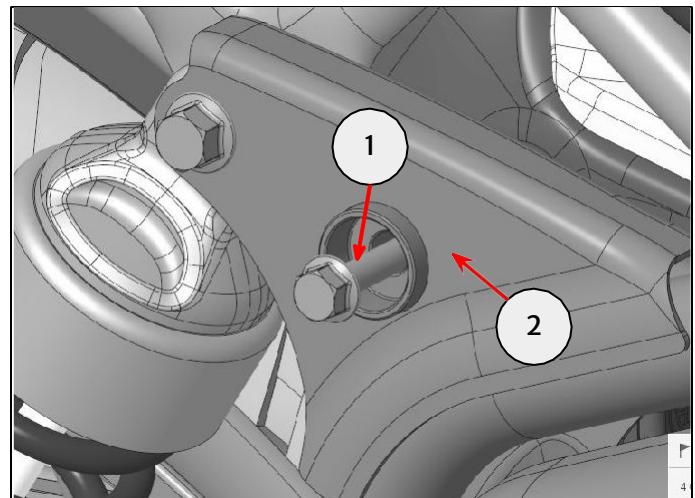
**25** Setze eine Distanzhülse mit Flansch (1) aus dem Montagesatz in die Vertiefung (2) im Motorradrahmen ein.
