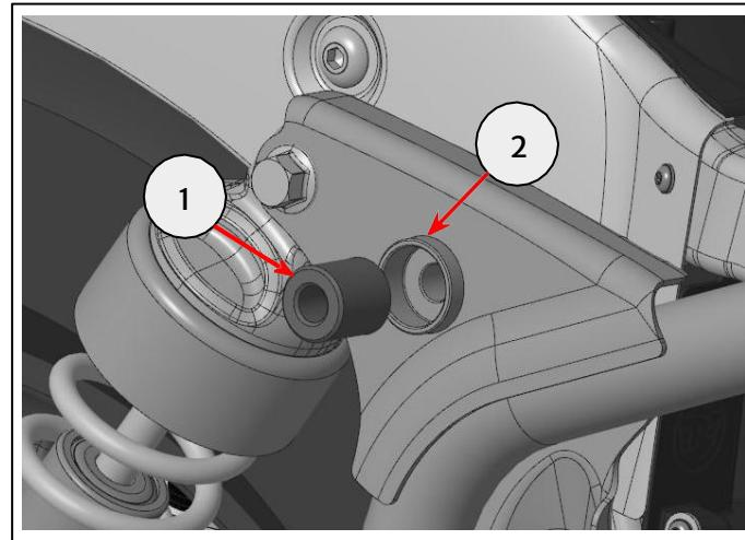
**2** Befestige die obere Aufhängung des rechten Taschenträgers (1) mit einer Befestigung M8 x 70 mm (4) und Mutter M8 (5) aus dem Teilesatz am 24-mm-Distanzröhren (2) und am Motorradrahmen (3).
