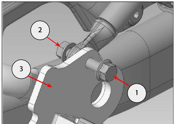
**33** Befestige die untere Halterung (1) des linken Taschenträgers mit einer Befestigung M8 x 30 mm (4), einem 3-mm-Distanzröhrrchen (5) und einer Mutter M8 (6) aus dem Teilesatz wie gezeigt durch den hinteren Montagerahmen (3) hindurch an der Halterung am Motorradrahmen (2).
