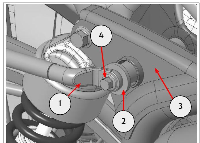
**27** Entferne die Befestigung (1) und Mutter (2) wie gezeigt vom Motorradrahmen (3). Bewahre die Befestigung (1) und Mutter (2) für den Fall auf, dass das Motorrad wieder in seinen ursprünglichen Zustand versetzt werden soll.
