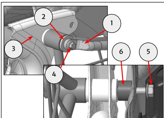
**19** Befestige die untere Aufhängung des Gepäcktaschenträgers (1) mit einer Befestigung M8 x 25 mm (4) und Mutter M8 (5) aus dem Teilesatz wie gezeigt an der Sari-Schutz-Halterung (2) und am Motorradrahmen (3).
