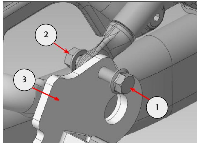
**38** Befestige die untere Halterung (1) des linken Taschenträgers mit einer Befestigung M8 x 40 mm (4), einem 9-mm-Distanzröhren (5) und einer Mutter M8 (6) aus dem Teilesatz wie gezeigt durch den hinteren Montagerahmen (3) hindurch an der Halterung am Motorradrahmen (2).
