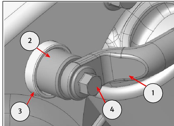
**37** Entferne die Befestigung (1) und Mutter (2) wie gezeigt vom Motorradrahmen (3). Bewahre die Befestigung (1) und Mutter (2) für den Fall auf, dass das Motorrad wieder in seinen ursprünglichen Zustand versetzt werden soll.
