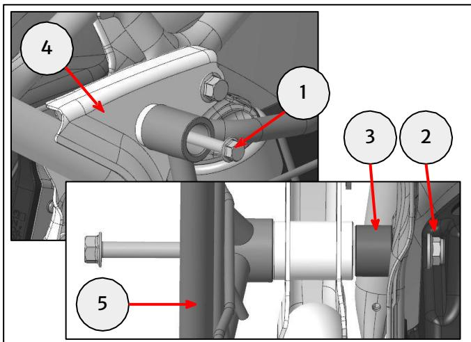
**17** Setze die Distanzhülse mit Flansch (1) aus dem Teilesatz in die Vertiefung (2) im Sari-Schutz ein.
