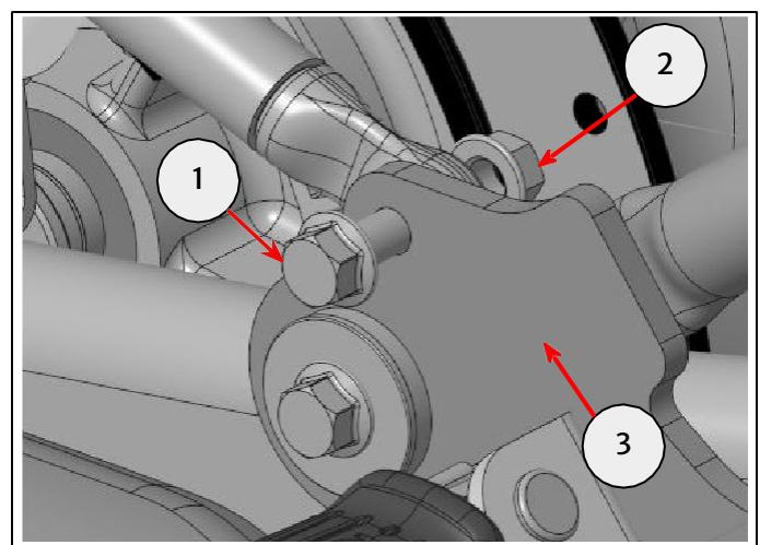
**28** Befestige die untere Halterung (1) des rechten Taschenträgers mit einer Befestigung M8 x 30 mm (4), einem 3-mm-Abstandhalter (5) und einer Mutter M8 (6) aus dem Teilesatz wie gezeigt durch den hinteren Montagerahmen (3) hindurch an der Halterung am Motorradrahmen (2).
