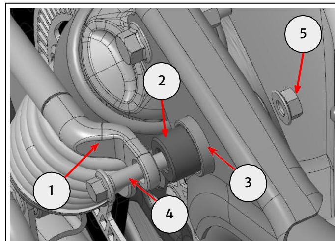
**3** Befestige die untere Aufhängung des rechten Taschenträgers (1) mit der Halterung am Motorradrahmen (2). Verwende dafür eine Befestigung M8 x 25 mm (3) und Mutter M8 (4) aus dem Montagesatz.
