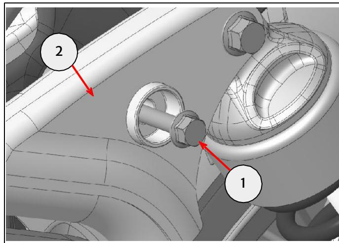
**30** Setze ein 55-mm-Distanzröhrenchen (1) aus dem Montagesatz in die Vertiefung (2) im Motorradrahmen ein.
