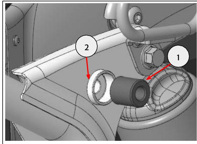
**9** Befestige die obere Aufhängung des linken Taschenträgers (1) mit einer Befestigung M8 x 70 mm (4) und Mutter M8 (5) aus dem Teilesatz am 24-mm-Distanzrörchen (2) und am Motorradrahmen (3).
