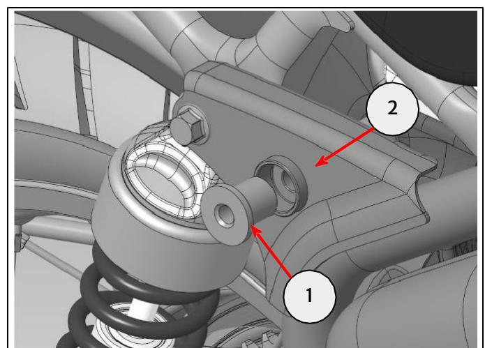
**26** Befestige die obere Aufhängung des rechten Taschenträgers (1) mit einer Befestigung M8 x 80 mm (4) aus dem Montagesatz wie gezeigt an der Distanzhülse mit Flansch (2) und dem Motorradrahmen (3).
