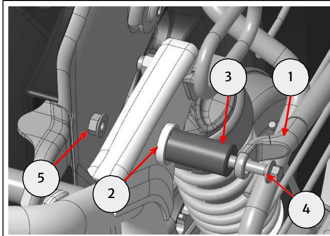
**7** Befestige die untere Halterung des Gepäcktaschenträgers (1) mit einer Befestigung M8 x 25 mm (3) und Mutter M8 (4) aus dem Teilesatz wie gezeigt an der Sari-Schutz-Halterung (2).
