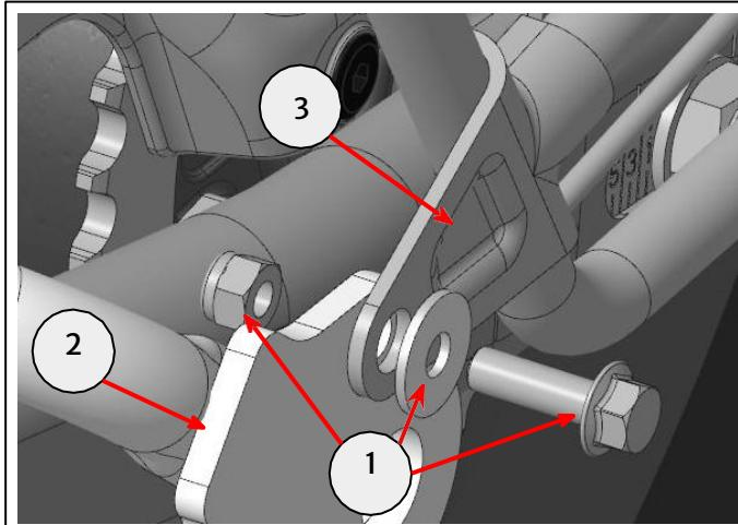
**16** Entferne die Befestigung (1), die Mutter (2) und den Abstandhalter (3), mit denen der Sari-Schutz (5) wie gezeigt befestigt ist, vom Motorradrahmen (4). Bewahre die Mutter (2) und den Abstandhalter (3) zur Wiederverwendung auf. Bewahre die Befestigung (1) für den Fall auf, dass das Motorrad wieder in seinen ursprünglichen Zustand versetzt werden soll.
