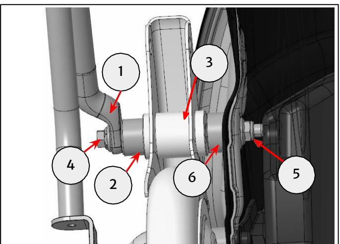
**23** Befestige die untere Aufhängung des linken Taschenträgers (1) mit einer Befestigung M8 x 40 mm (4) und Mutter M8 (5) aus dem Teilesatz wie gezeigt an der Halterung am Motorradrahmen (2) und einem 18-mm-Distanzrörchen (3).
