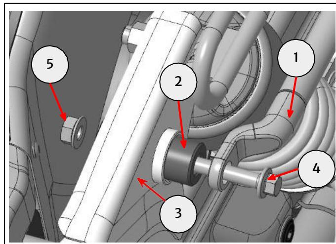
**10** Befestige die untere Aufhängung des linken Taschenträgers (1) mit einer Befestigung M8 x 40 mm (4) und Mutter M8 (5) aus dem Teilesatz wie gezeigt an der Halterung am Motorradrahmen (2) und einem 18-mm-Distanzrörchen (3).
