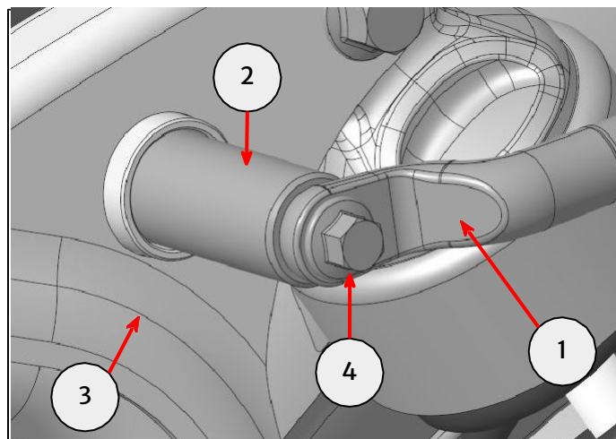
**32** Entferne die Befestigung (1) und Mutter (2) wie gezeigt vom Motorradrahmen (3). Bewahre die Befestigung (1) und Mutter (2) für den Fall auf, dass das Motorrad wieder in seinen ursprünglichen Zustand versetzt werden soll.
