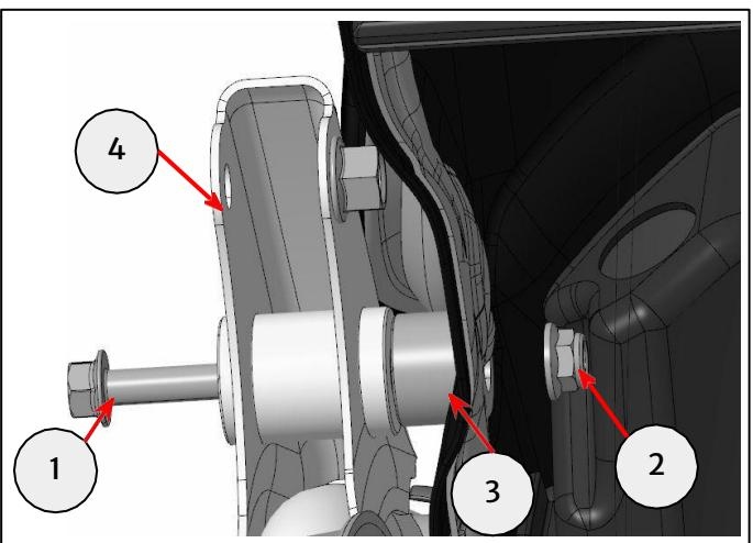
**21** Setze ein 24-mm-Distanzrörhrchen (1) aus dem Montagesatz in die Vertiefung (2) im Motorradrahmen ein.
