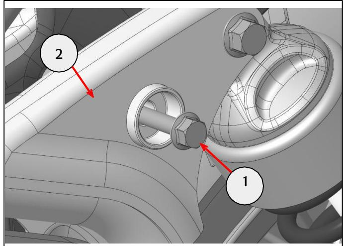
**35** Setze ein 24-mm-Distanzröhrrchen (1) aus dem Montagesatz in die Vertiefung (2) im Motorradrahmen ein.
