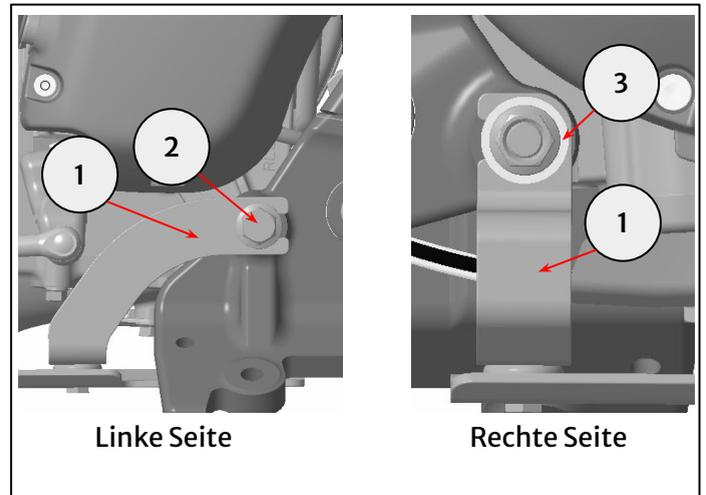
**6** Bringen Sie den Ölwanenschutz (1) mit den Befestigungen M6 x 20 mm aus dem Teilesatz (2) an den Halterungen an und verwenden Sie dabei unter den unteren Befestigungen eine Unterlegscheibe 19 x 1 mm (3) aus dem Teilesatz.
