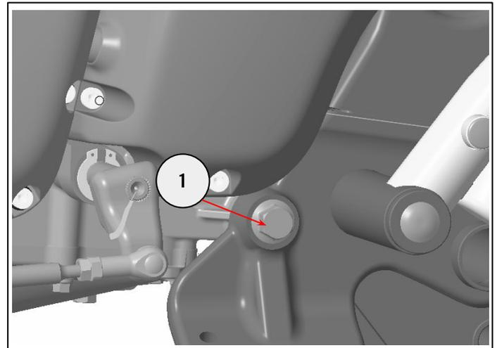
**5** Schieben Sie die hintere Halterung (1) auf der linken Seite zwischen die untere Motorhalterung und die Befestigung (2) und auf der rechten Seite zwischen die untere Motorhalterung und die Unterlegscheibe (3).
