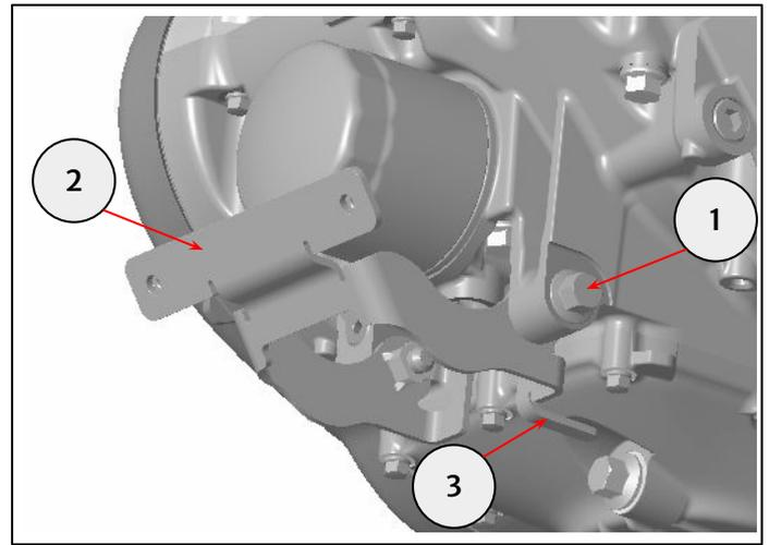
**4** Lockern Sie die untere Motorbefestigung (1).
