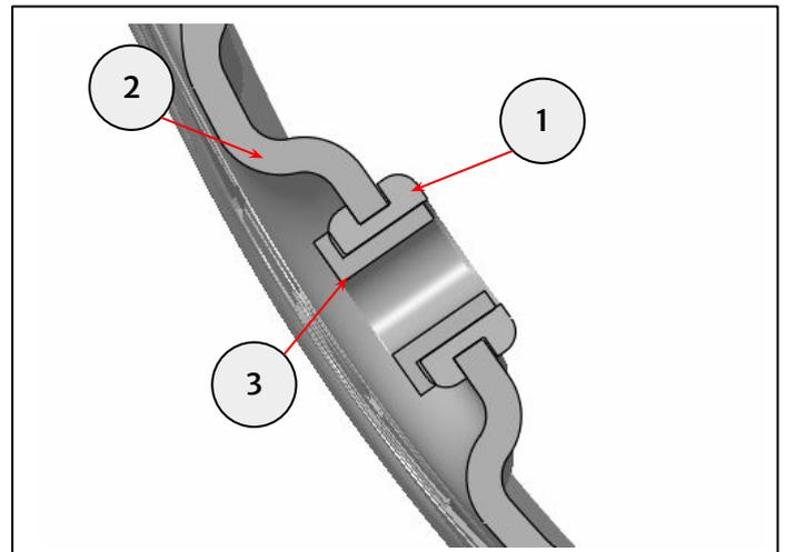
**2** Setzen Sie die Gummitüllen M10 (1) in den Ölwanenschutz (2) ein. Setzen Sie die Abstandhalter 15 x 8 mm (3) in die hinteren Gummitüllen ein.
