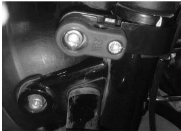
**8** Deslice las barras de montaje del parabrisas tintado (5) en los soportes inferiores (2) y coloque la cúpula a la altura deseada del faro delantero. Se recomienda una separación de 10 mm del bisel del faro delantero.
