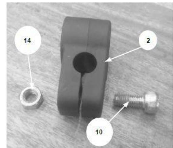
**6** Monte sin apretar el manguito de goma (8), la abrazadera de la horquilla interior (6) y la abrazadera de la horquilla exterior (7) alrededor del tubo de la horquilla y monte el soporte inferior (2) en el exterior de la horquilla con un perno M8 (12) y una tuerca Nyloc M8 (16). Coloque sin apretar sólo en esta etapa. Repita el paso 6 para la horquilla restante.
