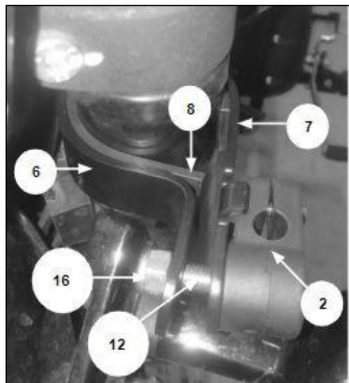
**7** Coloque la disposición de abrazaderas en el tubo de la horquilla de tal manera que haga tope con la superficie superior. Utilizando el soporte del indicador de dirección como guía, alinee las abrazaderas de manera que queden paralelas y apriete la tuerca Nyloc M8 (16) a 25 Nm. Repita el paso 7 para el conjunto de la abrazadera de la horquilla restante.
