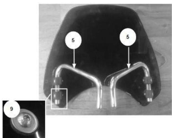
**5** Monte sin apretar el soporte inferior (2) con un perno M6 (10) y una tuerca M6 (14). Coloque sin apretar sólo en esta etapa. Repita el paso 5 para el soporte inferior restante.
