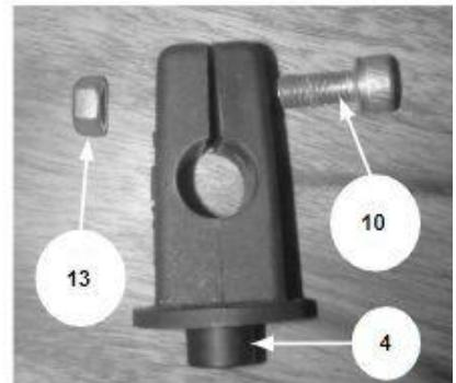
**3** Coloque a presión una tuerca M5 (13) en el bolsillo de las 4 abrazaderas de montaje de la cúpula (4) y monte sin apretar en el parabrisas tintado (1) a través de los pasatubos de goma (3) con un perno M5 (9) y una arandela M5 (15). Coloque sin apretar sólo en esta etapa.
