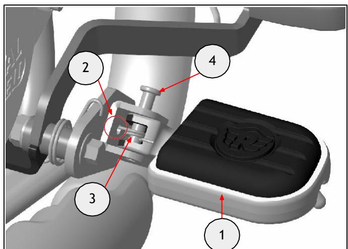
**7** Coloque la arandela de retención (1) retirada en el paso 1 en la ranura del pasador de horquilla (2).
