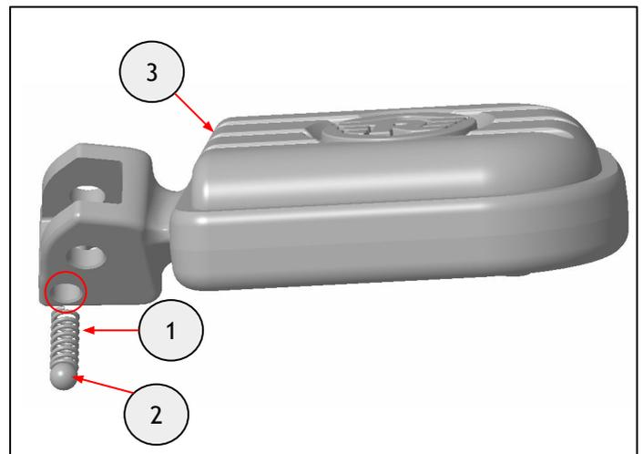
**8** Tout en maintenant la bille et le ressort de détente en place, alignez le trou de montage du repose-pied (1) sur le trou de chape (2).
