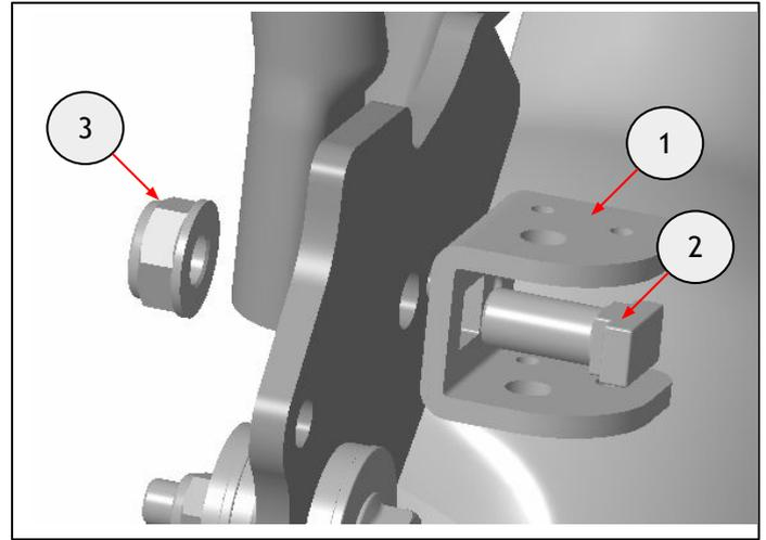
**6** Montez la plaque de chape (1) du kit sur le châssis à l'aide de la fixation (2) et de l'écrou (3) déposés à l'étape 5. Ne serrez pas complètement à ce stade.
