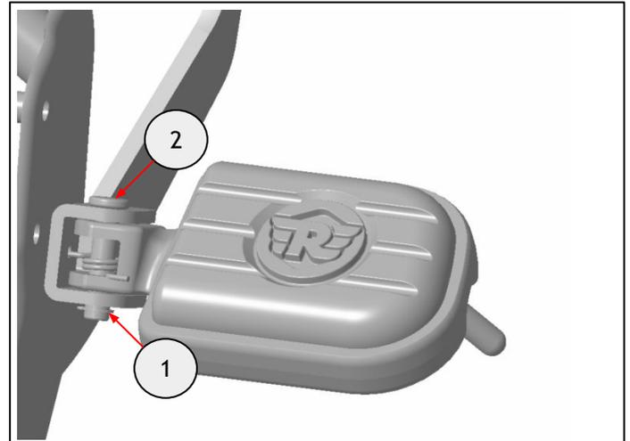
**Remarque :** Appliquez de la graisse sur le circlip pour éviter qu'il rouille.
