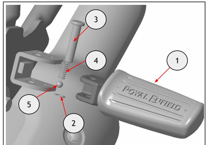
Conservez le circlip, le ressort de détente et la bille pour les réutiliser si nécessaire. Conservez la goupille de chape et le repose-pied pour pouvoir les réutiliser si la moto est remise dans son état d'origine.
