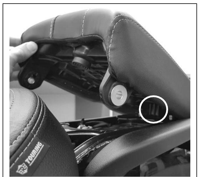
**9** Refixer la selle passager en réutilisant le boulon à tête six pans creux (1) déposé précédemment. L'insérer à travers le bossage de poignée-barre et dans le cadre. Le serrer à **25 Nm** et répéter l'opération de l'autre côté.
