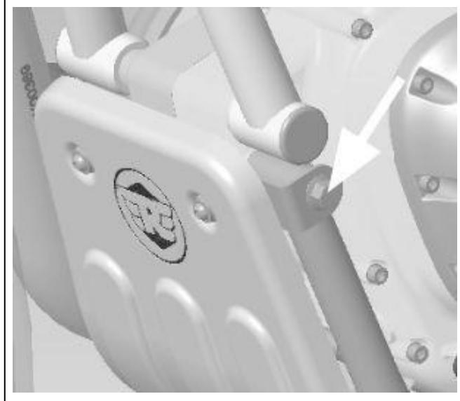
**7** Überprüfe alle Bedienelemente, einschließlich Schalt- und Bremspedal, auf Abstand zum Ölwanenschutz, bevor das Fahrzeug betätigt wird.
