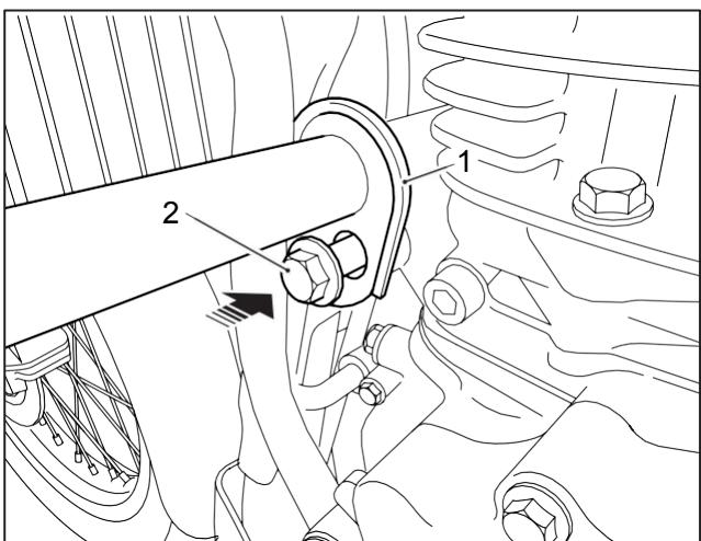
**4** Aligner le support inférieur de la protection moteur (1) avec le point de montage sur le cadre de la moto (2), comme illustré.
