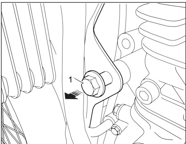
**3** Aligner le support supérieur de la protection moteur gauche (1) avec l'emplacement du support moteur supérieur et reposer la fixation d'origine (2), comme illustré.
