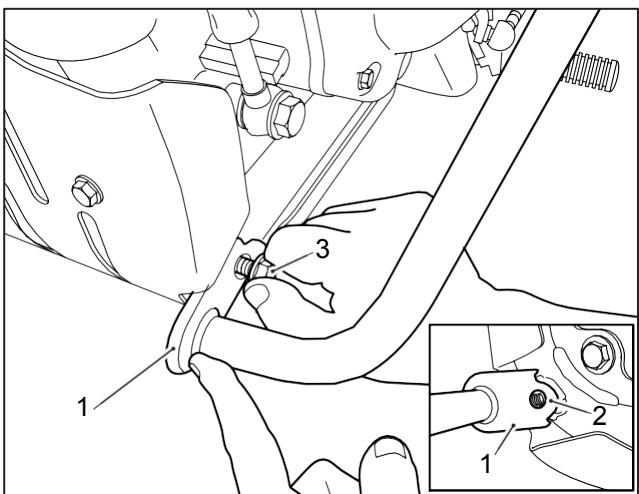
**5** Installer le support supérieur de la protection moteur droite (1) sur la fixation du support moteur et reposer l'écrou d'origine (2) comme illustré.
