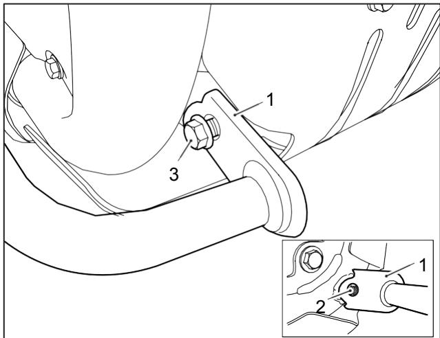
**7** Tout en maintenant l'écrou de fixation du support moteur supérieur sur le côté droit de la moto, serrer la fixation du support moteur supérieur à **50 Nm**.
