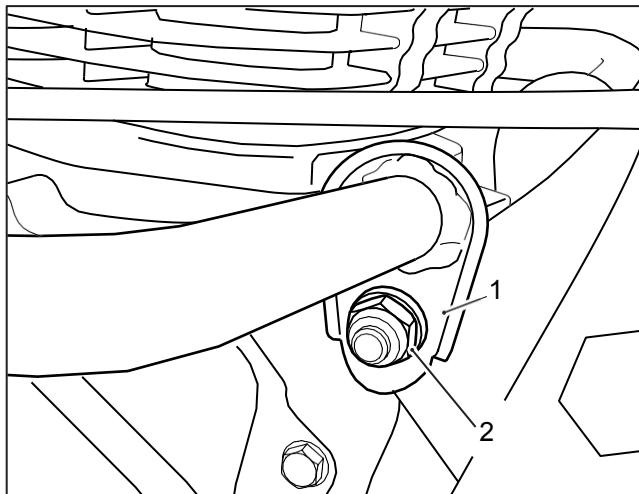
**6** Aligner le support inférieur de la barre de protection du moteur (1) avec le point de montage sur le cadre de la moto (2). Monter la fixation M8 x 12 mm (3) provenant du kit.
