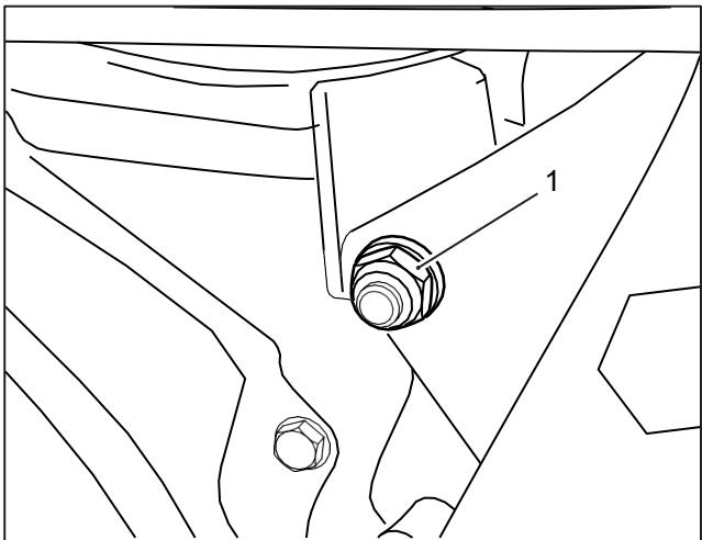
**2** Déposer la fixation supérieure du support moteur (1). Conserver la fixation pour la réutiliser.
