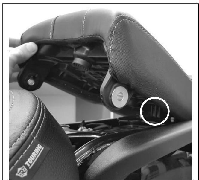
**9** Ricollegare la sella del passeggero riutilizzando il bullone a testa cilindrica (1) rimosso in precedenza. Inserire attraverso il tronchetto del maniglione e nel telaio. Serrare a **25 Nm** e ripetere sull'altro lato.
