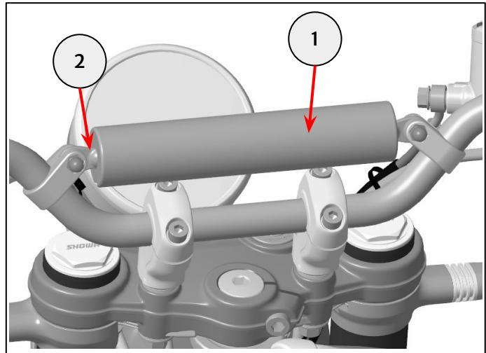
**3** Con la gommapiuma (1) in posizione, posizionare la copertura (2) come mostrato, con la chiusura a strappo rivolta verso l'alto (3).
