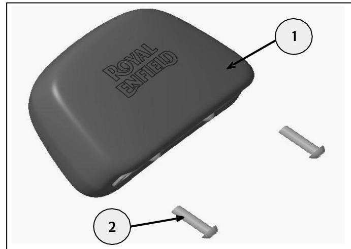
**6** Utilize a almofada do encosto do passageiro guardada na etapa 5, coloque-a sobre as alças de segurança e utilize as fixações (2) guardadas na etapa 5 para montar, como mostrado. Aperte a 25 Nm.
