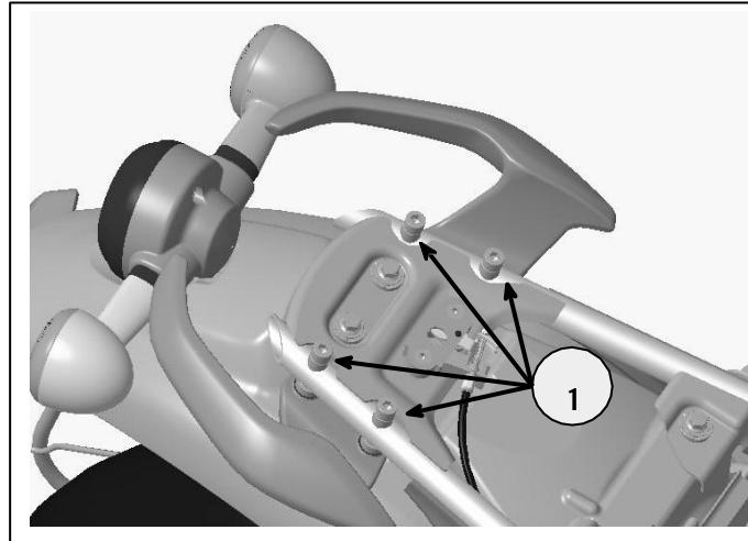
**2** Remova a fixação do protetor do sari (1) do lado esquerdo da motocicleta e descarte. Remova a alça de segurança existente.
