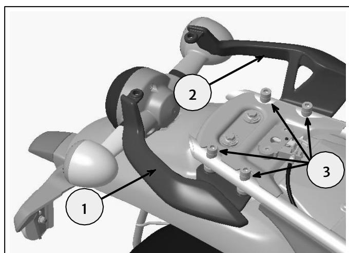
**4** Utilize a fixação (3) do kit para montar o suporte de montagem do protetor de sari (2) com a alça de segurança direita (1), como mostrado. Aperte a 10 Nm. Remonte o assento removido na etapa 1.
