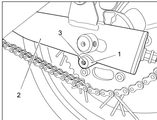
**3** Posizionare uno dei nottolini per il forcellone (1) forniti nel kit sul lato sinistro del forcellone e allinearla alla flangia di montaggio filettata (2). Inserire una vite (3) fornita nel kit per fissare il nottolino al forcellone.
