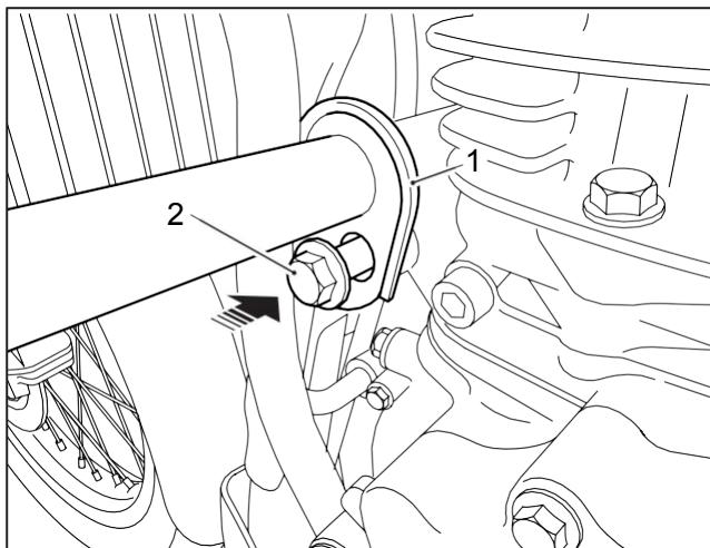
**4** Allineare l'attacco inferiore del paramotore (1) al punto di montaggio sul telaio della motocicletta (2) come illustrato.
