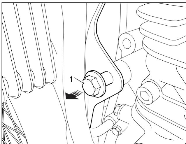
**3** Allineare l'attacco superiore del paramotore sinistro (1) alla posizione dell'attacco superiore del motore e rimontare la vite originale (2) come illustrato.
