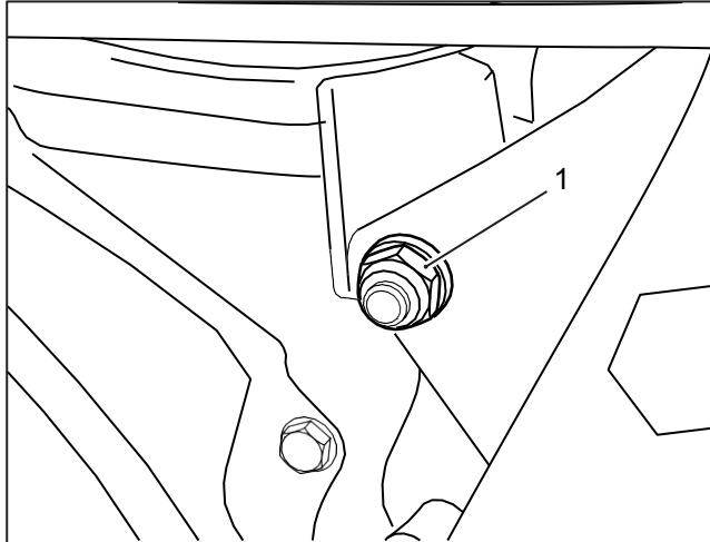
**2** Rimuovere la vite superiore dell'attacco motore (1). Conservare la vite per il riutilizzo.
