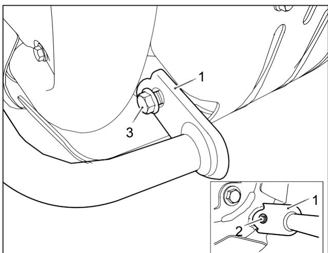
**7** Tenendo fermo il dado di fissaggio superiore dell'attacco motore sul lato destro della motocicletta, serrare la vite superiore dell'attacco motore a **50 Nm**.
