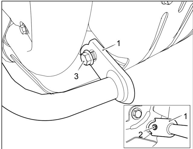
**7** Tenendo fermo il dado di fissaggio dell'attacco superiore del motore sul lato destro della motocicletta, serrare la vite superiore dell'attacco motore a **50 Nm**.
