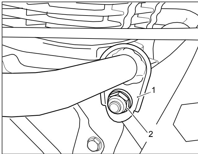
**6** Allineare l'attacco inferiore del paramotore (1) al punto di montaggio sul telaio della motocicletta (2). Inserire la vite M8 x 12 mm (3) fornita nel kit.
