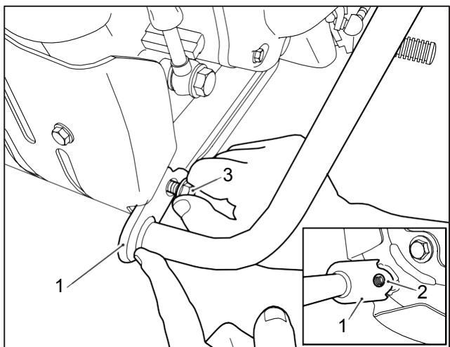
**5** Infilare l'attacco superiore del paramotore destro (1) sulla vite dell'attacco motore e rimontare il dado originale (2) come illustrato.
