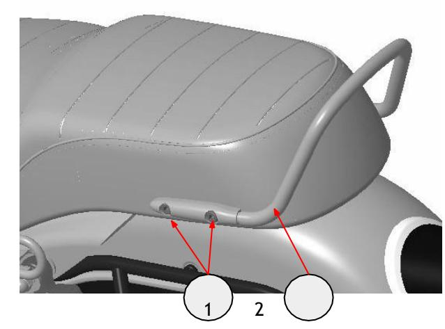
**2** Retire el conjunto del asiento (1) del vehículo. Guárdelas para volver a utilizarlas si la motocicleta se va a volver a dejar en su estado original.
