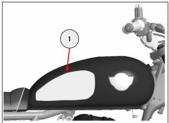
**3** Entfernen Sie die selbstklebende Schutzfolie von der Rückseite eines linken Tank Pads (1) (das durch ein "L" auf dem roten Kunststoff gekennzeichnet ist). Richten Sie das Tank Pad sorgfältig so aus, dass es 22 mm Abstand zum Tankradius (2) und 24 mm Abstand zur Unterkante (3) des Tanks hat. Das Tank Pad sitzt dann vollständig in der Vertiefung des Kraftstofftanks.
