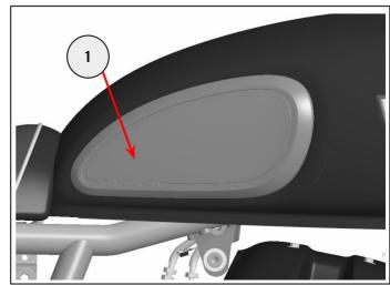
**5** Lassen Sie die Tank Pads vor der Verwendung 24 Stunden lang bei einer Umgebungstemperatur zwischen 15°C und 30°C aushärten.
