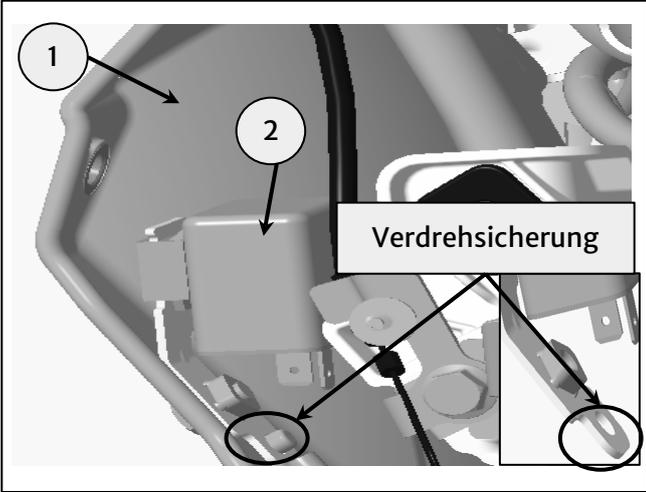
**30 IND und Europa:** Verlegen Sie das Minuskabel (3) der Blinkeinheit wie gezeigt unter dem Sitzentriegelungszug (3) weiter über der Batterie. Bringen Sie den Piece Kotflügel (1) wie gezeigt mit der in Schritt 26 aufbewahrten Befestigung M6 x 16 (2) an. Anzugsmoment **5 Nm**.
