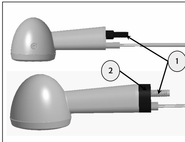
**6** Bringen Sie den Blinker mit dem roten Stecker mit der in Schritt 4 aufbewahrten Mutter (1) an der rechten Halterung an und ziehen Sie ihn auf **6 Nm** an. Halten Sie Blinker und Isolator mit einem 24-mm-Schraubenschlüssel gegen (nur gegenhalten, keine Kraft ausüben). Wiederholen Sie den Schritt für die linke Seite, mit dem Blinker mit dem grünen Stecker.
