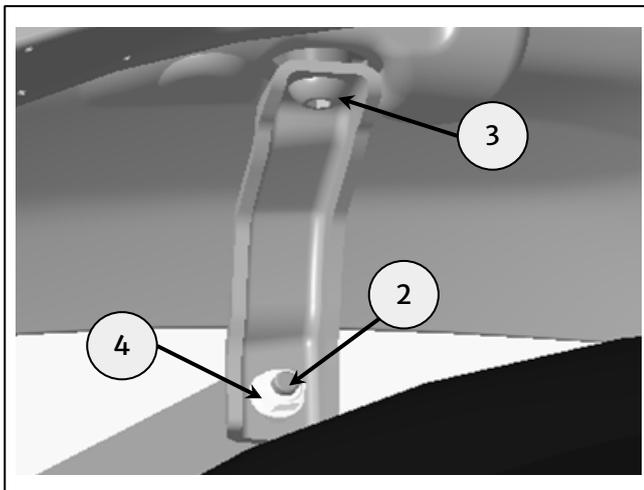
**26** Entfernen Sie den Satz aus Befestigung und Unterlegscheibe (3), um den Zusammenbau (2) aus Blinkereinheit und Halterung zu lösen. Entfernen Sie Befestigungen (4) und Befestigung (5), um den Piece Kotflügel (1) zu lösen. Lassen Sie ihn so hängen.
