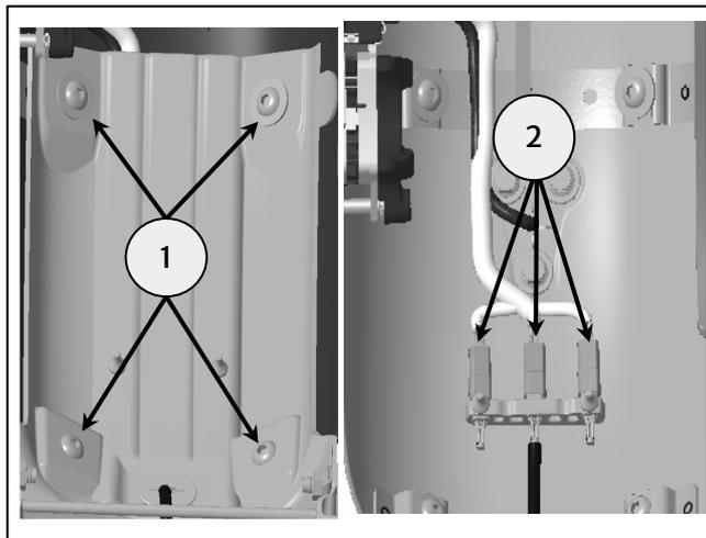
**11** Lösen Sie die Muttern (1) und bauen Sie die vorhandenen Blinker auf der linken und rechten Seite vom Schmutzfänger ab. Bewahren Sie die Muttern zur Wiederverwendung auf.
