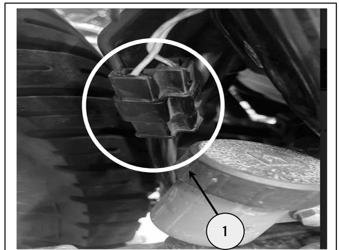
**29** Bringen Sie die Verdrehsicherungsöffnung in Position und richten Sie das Befestigungsloch des Zusammenbaus (2) aus Blinkeinheit und Halterung wie gezeigt auf den Piece Kotflügel (1) aus. Verwenden Sie die Befestigung und Unterlegscheibe (3) aus Schritt 26. Anzugsmoment **6 Nm**.
