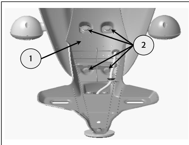
**25** Montieren Sie die Heckkotflügelbaugruppe mit den in Schritt 12 aufbewahrten Befestigungen (1), (2) und (3) und der Mutter (4) wieder am Fahrzeug. Anzugsmoment **10 Nm**.
