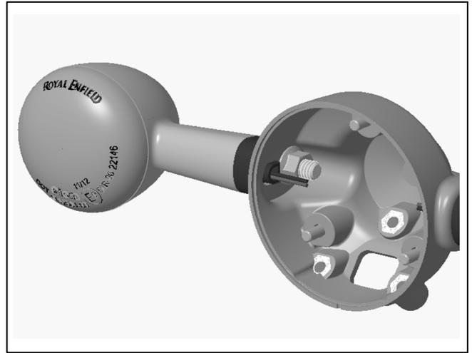
**21** Bringen Sie die Rückleuchte mit den in Schritt 15 aufbewahrten Befestigungen (1) wieder am Rückleuchtengehäuse an. Anzugsmoment **3 Nm**.
