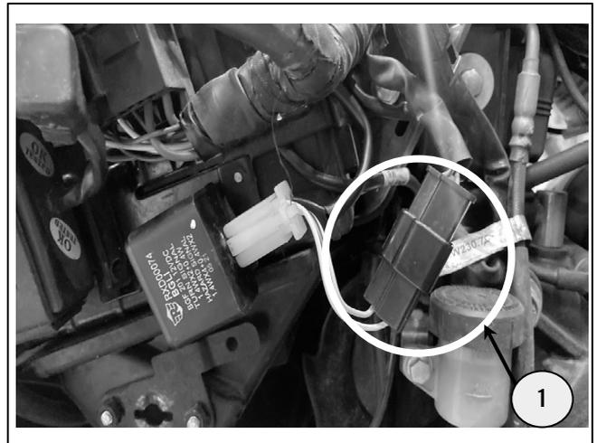
**35 IND und Europa:** Schließen Sie das Minus-Verlängerungskabel der Blinkleinheit wie gezeigt an der Batterie an. Achten Sie darauf, dass das Kabel richtig, wie gezeigt, verlegt wird.
