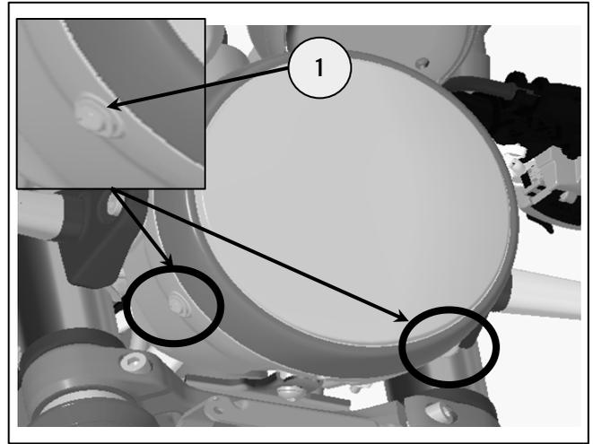
**2** Lösen Sie die Befestigungen (2) im Inneren der Scheinwerfereinheit und entfernen Sie die Abdeckung (1). Stecken Sie die Anschlussstecker für den rechten und linken Blinker im Inneren der Scheinwerfereinheit ab. Bewahren Sie Abdeckung und Befestigungen zur Wiederverwendung auf.
