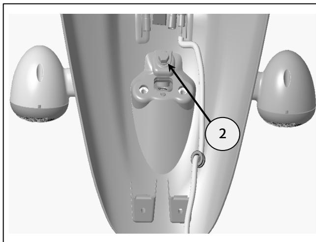
**15** Entfernen Sie die Befestigungen (1), um das Rückleuchtengehäuse zu öffnen, und lösen Sie die Mutter (2), um die vorhandenen Blinker auf der linken und rechten Seite auszubauen. Zur späteren Verwendung aufbewahren.
