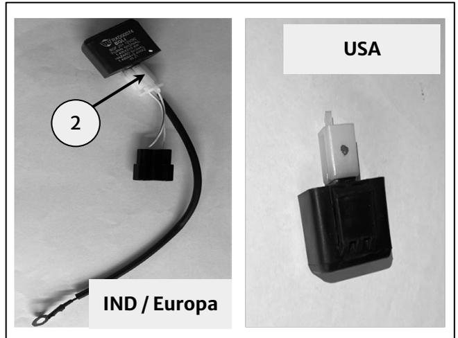
**34 IND und Europa:** Verbinden Sie den 2-poligen Stecker der Blinkleinheit wie gezeigt mit dem Fahrzeugkabelbaum (1).
