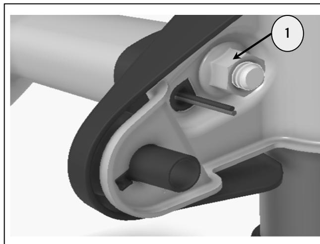
**7** Bringen Sie die Scheinwerfereinheit samt Halterung mit den in Schritt 3 aufbewahrten Befestigungen (1), Muttern (2) und Unterlegscheiben (3) wieder an. Anzugsmoment **10 Nm**. (Halten Sie die Mutter (2) von innerhalb der Scheinwerfereinheit gegen). Führen Sie das Verfahren nicht gleichzeitig auf der linken und rechten Seite durch.
