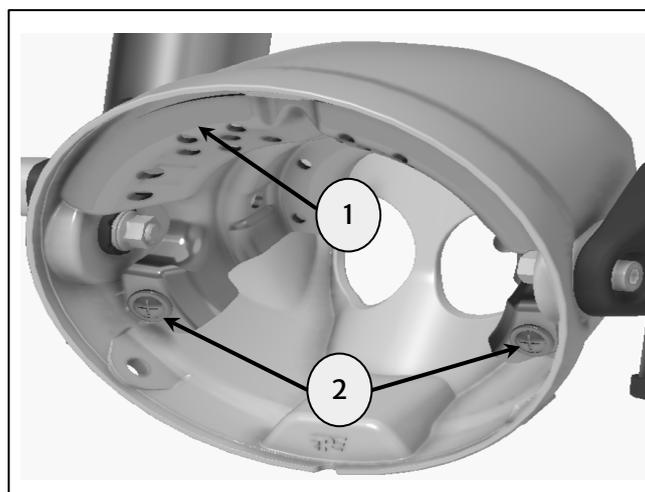
**9** Bringen Sie den Scheinwerfer (1) mit den in Schritt 2 aufbewahrten Befestigungen (2) wieder an der Scheinwerfereinheit an. Anzugsmoment **5 Nm**.
