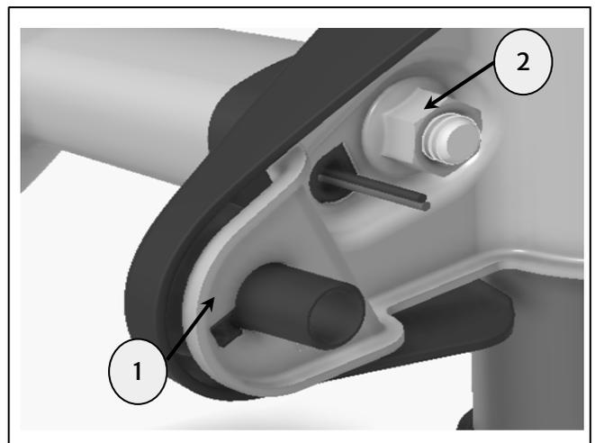
**5** Setzen Sie die Bolzenbefestigung (1) aus dem Montagesatz in den Zubehörblinker ein und ziehen Sie sie auf **6 Nm** an. Platzieren Sie einen Isolator (2) aus dem Montagesatz wie gezeigt über der Befestigung. Wiederholen Sie den Schritt für die übrigen Blinker.
