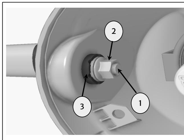
**8** Schließen Sie die Blinkerstecker an die Fahrzeugstecker im Inneren der Scheinwerfereinheit an (rot an rot und grün an grün). Bringen Sie die Abdeckung (1) mit den in Schritt 2 aufbewahrten Befestigungen (2) wieder im Inneren der Scheinwerfereinheit an.
