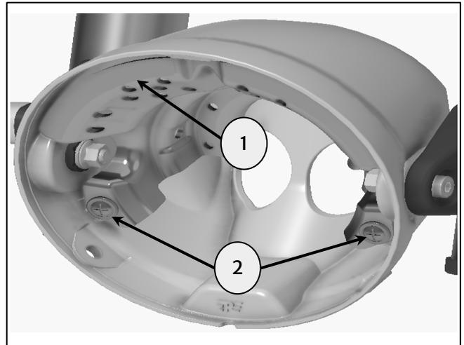
**3** Entfernen Sie die Befestigung (1), Mutter (2) und Unterlegscheibe (3) von der rechten Seite der Scheinwerferhalterung (halten Sie die Mutter von innerhalb der Scheinwerfereinheit gegen). Bewahren Sie die Befestigung, Unterlegscheibe und Mutter zur Wiederverwendung auf. Wiederholen Sie den Schritt für den linken Blinker.
