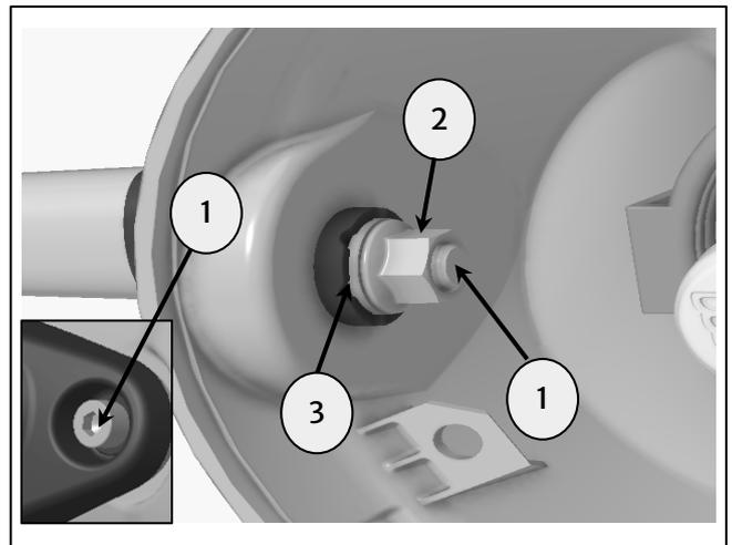
**4** Drehen Sie die rechte Halterung (1) nach außen, lösen Sie die Mutter (2) und nehmen Sie den Blinker von der Halterung ab. Wiederholen Sie den Schritt für die linke Seite. Bewahren Sie die Muttern zur Wiederverwendung auf.
