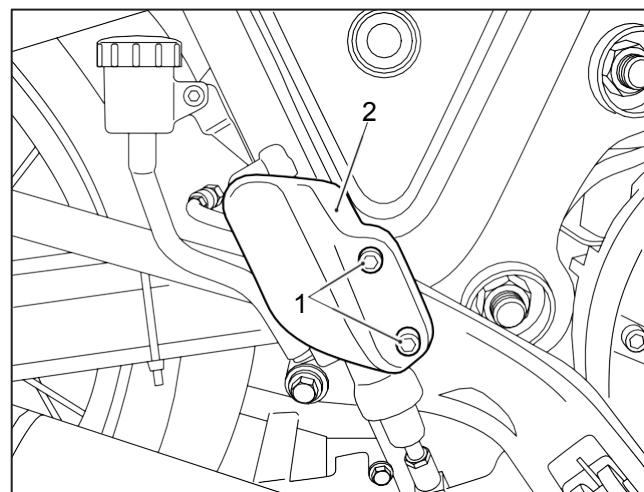
**2** Lege den linken Zubehör-Fersenschutz (2) so am Motorradrahmen an, dass er auf die Befestigungspositionen des Original-Fersenschutzes ausgerichtet ist. Bring die Originalbefestigungen (1) wieder an. Anzugsmoment **10 Nm**.
