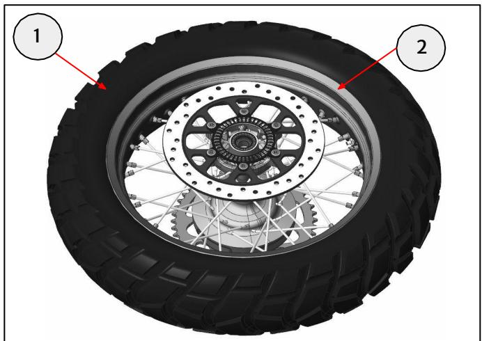
**7** Montiere den Reifen (1) auf dem neuen Rad (2). Der Laufrichtungspfeil auf dem Reifen muss nach vorne zeigen.
