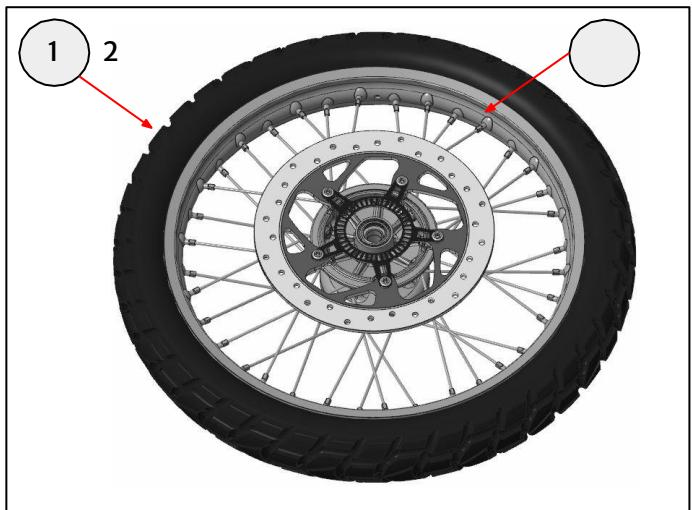
**3** Montiere den Reifen (1) auf dem neuen Rad (2). Der Laufrichtungspfeil auf dem Reifen muss nach vorne zeigen.
