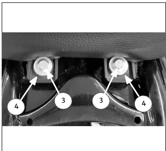
**4** Levante el asiento del conductor desde la parte trasera y tire hacia atrás para desengancharlo.
