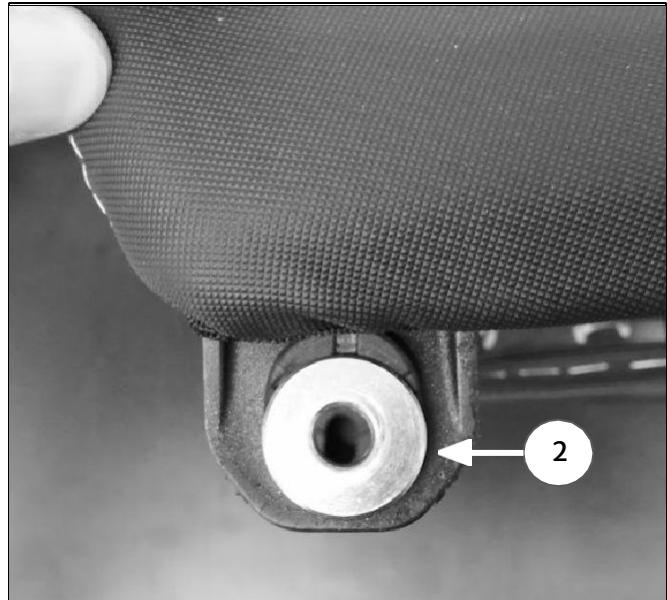
**8** Vuelva a insertar el gancho del asiento del pasajero trasero en el bastidor y alinee los orificios de montaje delanteros.
