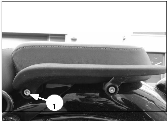
**2** Levante la parte delantera del asiento del pasajero y desengáñchelo del bastidor. Retire las inserciones del protector superior (2) de los lados izquierdo y derecho. Guarde para su uso futuro.
