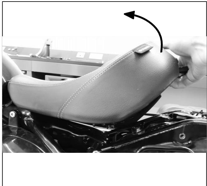
**5** Empuje la parte delantera del nuevo asiento del conductor de los accesorios hacia la lengüeta del depósito de combustible y alinee el punto de montaje trasero con el bastidor. Vuelva a colocar 2 inserciones del protector superior (4).
