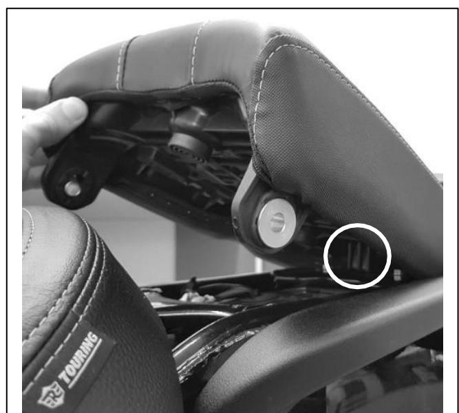
**9** Vuelva a acoplar el asiento del pasajero reutilizando el perno de cabeza hueca (1) retirado anteriormente. Introduzca a través del saliente del asa de agarre y en el bastidor. Apriete a **25 Nm** y repita en el otro lado.
