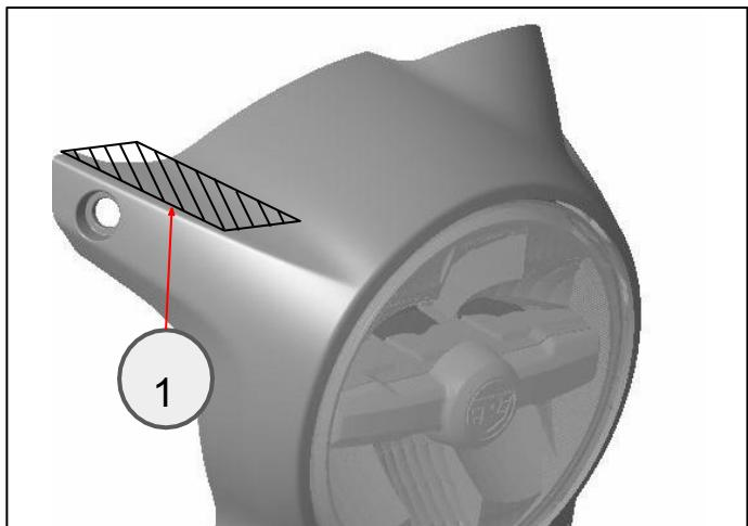
**7** Posicione a fita de proteção da pintura (1) na carcaça combinada.
