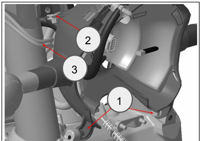
**10** Recoloque a carcaça nos olhais de borracha (1). Coloque as fixações (2) removidas na etapa 9.
