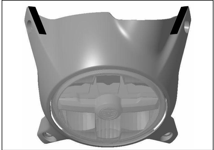
**9** Remova as fixações da carcaça do farol (1). Remova a carcaça dos olhais de borracha superiores (2). Gire a carcaça para a frente. Mova os cabos do acelerador (3) abaixo da fixação superior (2).
