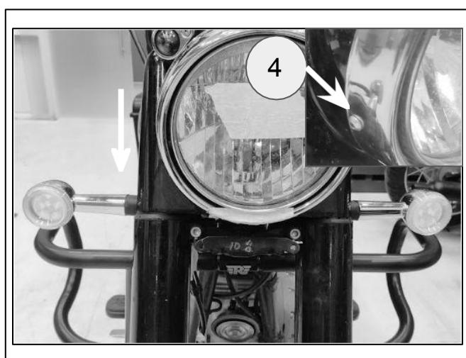
**7** Réutiliser les fixations (1) et (2) (côtés gauche et droit) sur le bloc optique de la nacelle et serrer la fixation (1) à **20 Nm** et (2) à **45 Nm**.
