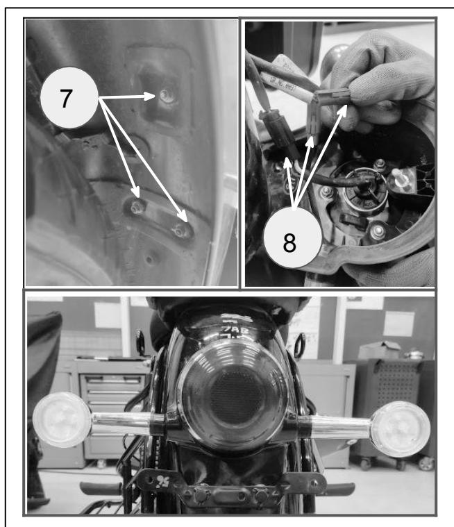
**Remarque :** Vérifier que les clignotants droit et gauche sont dirigés vers l'avant et les régler si nécessaire
