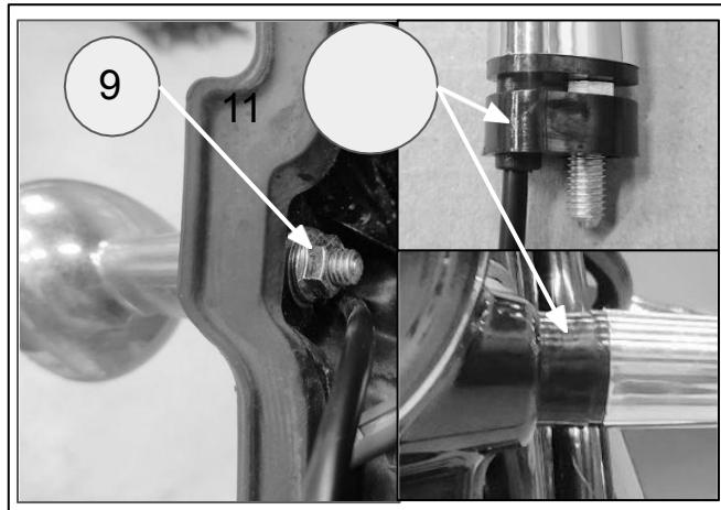
**12** Raccorder les trois connecteurs de l'ensemble feu arrière avec le faisceau du véhicule. Le clignotant droit avec connecteur VERT doit être branché au connecteur VERT du faisceau du véhicule. Le clignotant gauche avec connecteur ROUGE doit être branché au connecteur ROUGE du faisceau du véhicule.
