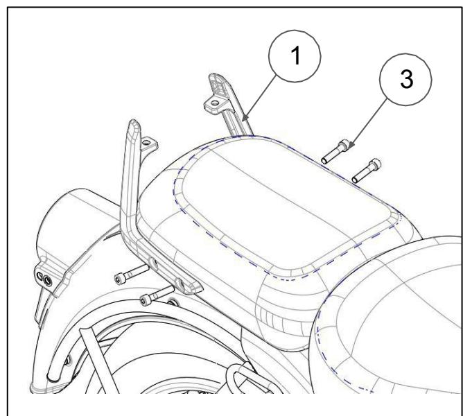
**4** Monte a almofada do encosto traseiro (2) com 2 parafusos de cabeça cilíndrica M8 x 40 (3). Aperte os parafusos a 25 Nm.
