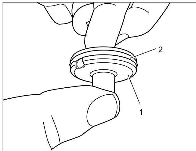
**6** Com o corpo da tampa de abastecimento de óleo (1) preso no cárter do motor, coloque sem apertar o inserto do logotipo (2) do kit no corpo da tampa de abastecimento de óleo, como mostrado. Gire o inserto do logotipo na orientação desejada.
