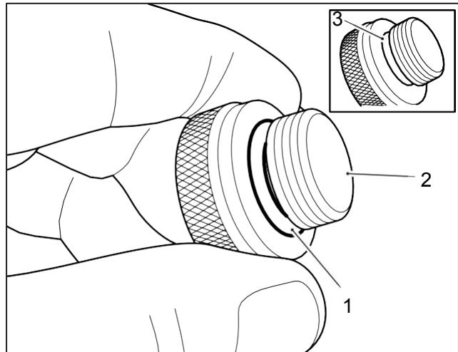
**3** Limpe a área ao redor da abertura do bocal de óleo (1) no cárter, removendo quaisquer detritos ou corrosão. Deve-se tomar cuidado para assegurar que detritos não entrem na abertura de abastecimento de óleo durante a operação de limpeza.
