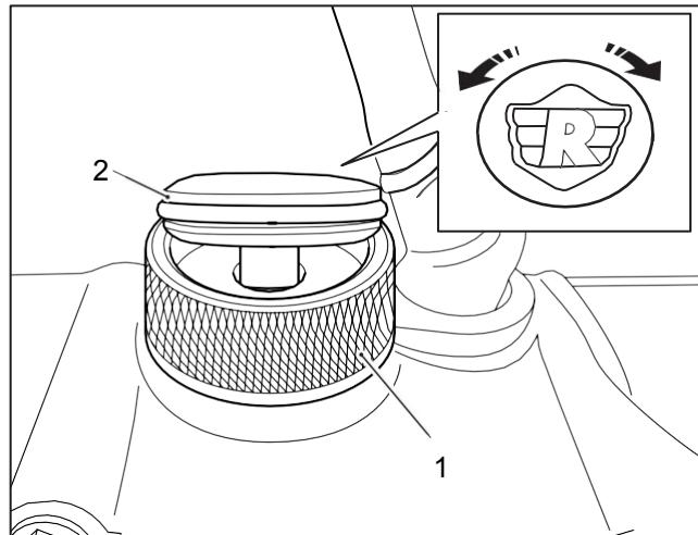
**7** Com o inserto do logotipo (1) na orientação desejada, pressione o inserto totalmente no corpo da tampa de abastecimento de óleo (2) com a mão até que a parte superior do inserto do logotipo fique nivelada com a borda superior do corpo da tampa de abastecimento de óleo.
