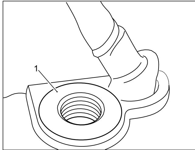
**4** Coloque o corpo da tampa acessória de abastecimento de óleo (1) no cárter do motor (2) e gire o corpo da tampa de abastecimento de óleo manualmente no sentido horário, até estar totalmente encaixada no cárter.
