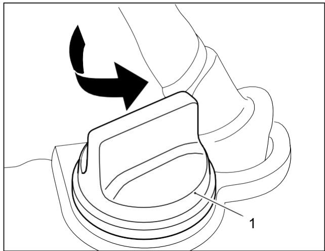
**2** Coloque o anel O-ring (1) do kit no corpo da tampa acessória de abastecimento de óleo (2), como mostrado. Certifique-se de que o anel O-ring esteja corretamente posicionado no sulco usinado (3) no corpo da tampa de abastecimento de óleo.
