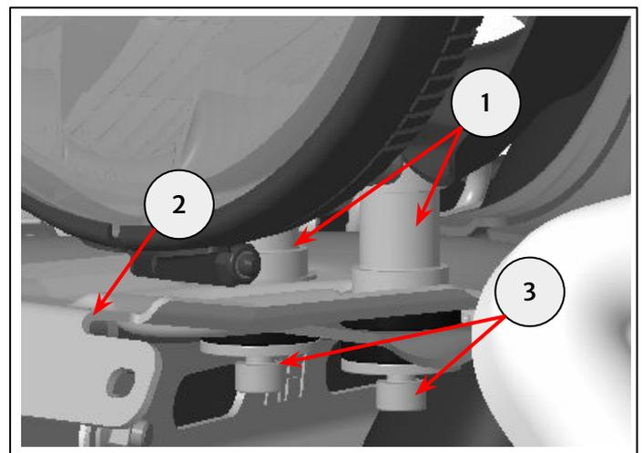
**13** Bringen Sie das Kennzeichen (1) mit den zuvor in Schritt 2 entfernten Befestigungen (2) wieder an.
