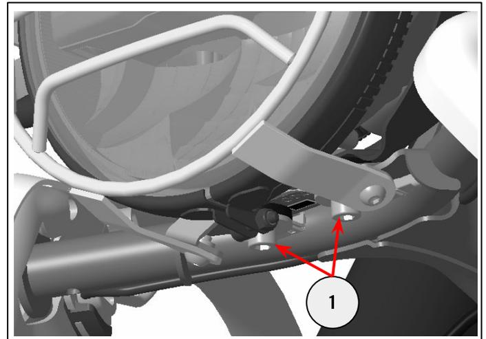
**15** Bringen Sie den Kotflügel (1) mit den zuvor in Schritt 2 entfernten Befestigungen (2) wieder an.
