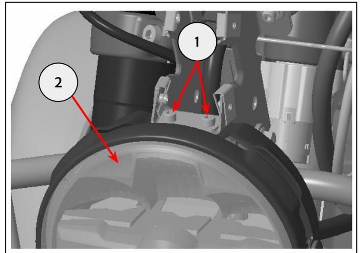
**8** Nehmen Sie die Montagehalterung (1) aus dem Montagesatz und befestigen Sie sie mit zwei mitgelieferten Befestigungen M5 x 8 mm (3) an den hinteren Aufnahmen (2) in der Scheinwerfereinheit.
