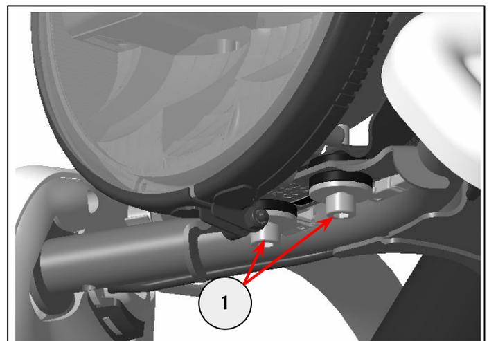
**5** Entfernen Sie die vier Befestigungen (1) der Windschutzscheibe (2). Bewahren Sie Befestigungen und Windschutzscheibe zur Wiederverwendung auf.
