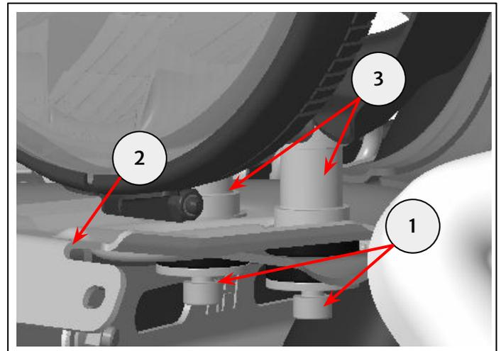
**4** Entfernen Sie die zwei Befestigungen an der Unterseite der Scheinwerfereinheit (1) und bewahren Sie sie zur Wiederverwendung auf.
