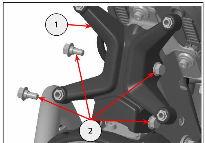
**17** Befestigen Sie die Windschutzscheibe (1) mit den zuvor in Schritt 5 entfernten Befestigungen (2) an der Windschutzscheibenhalterung.
