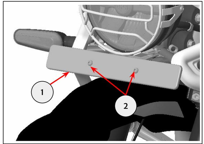
**14** Bringen Sie die zuvor in Schritt 4 entfernten unteren Befestigungen der Scheinwerferereinheit wieder an.
