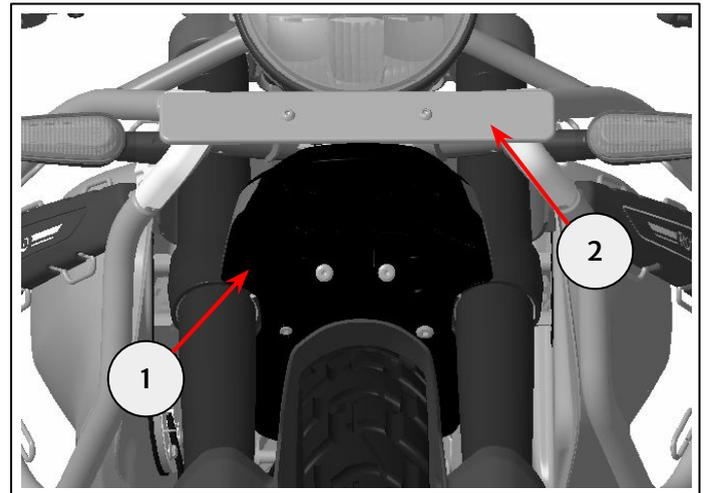
**3** Entfernen Sie die zwei Befestigungen (1), mit denen die Kennzeichenhalterung (2) und die Abstandhalter (3) befestigt sind, und bewahren Sie die Teile zur Wiederverwendung auf.
